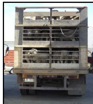
Foto 2. Carro metálico de 3 pisos para el transporte de ovinos (vista lateral y posterior).
