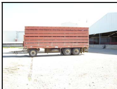
Foto 2. Carro metálico de 3 pisos para el transporte de ovinos (vista lateral y posterior).
