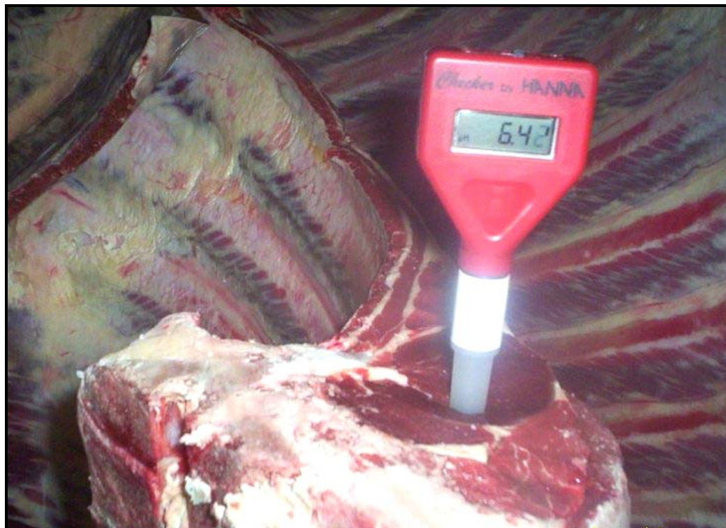
Figura 4. Peachímetro inserto en la profundidad del músculo Longissimus thoracis .
