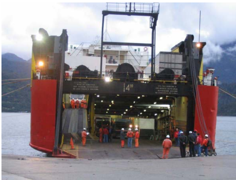
Figura 1: Compuerta de carga de la embarcación A, se observa que tiene acceso directo al piso del medio o cubierta principal (bajo la cubierta superior), al lado izquierdo se observa la rampa para subir a la cubierta superior.
