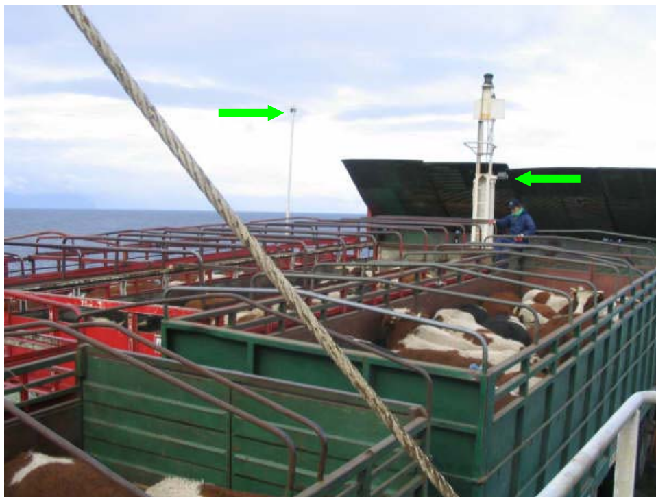
Figura 6: Iluminación de las embarcaciones en la cubierta superior, sin techo, basada en tres a cuatro focos.
