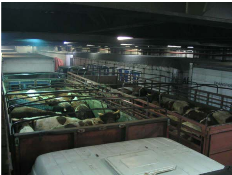
Figura 5: Iluminación en la cubierta principal con focos y tubos fluorescentes alineados. Nótese que el foco (esquina superior izquierda) ilumina de forma distinta a los tubos fluorescentes.
