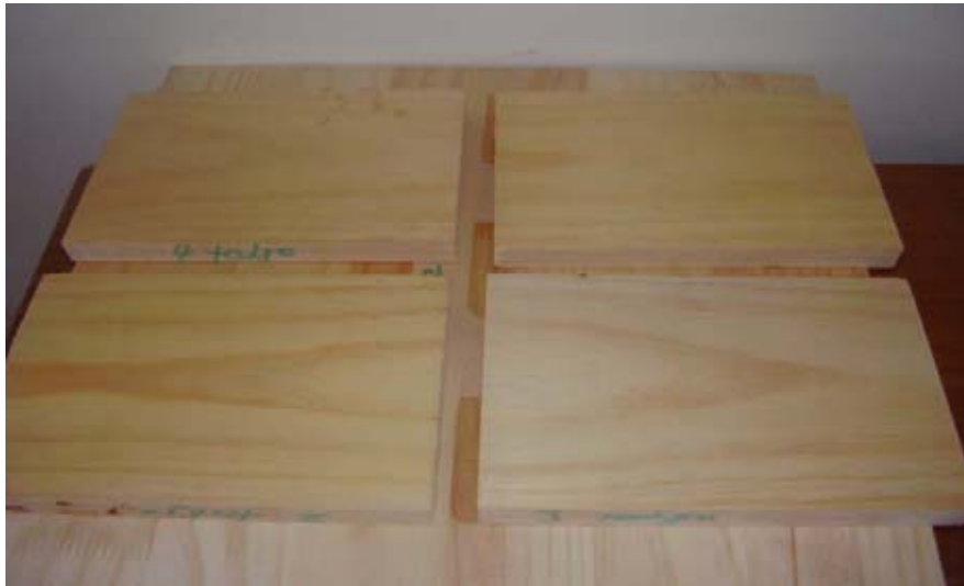
Figura 3: Forma y dimensiones de las probetas tipo para la medición y aplicación de los tratamientos líquidos.
