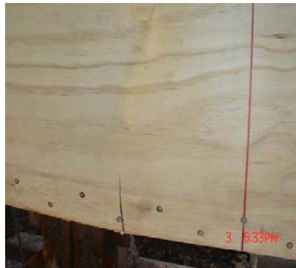
Viga 1 (VC 9): (Falla por pandeo y fractura del contrachapado)
