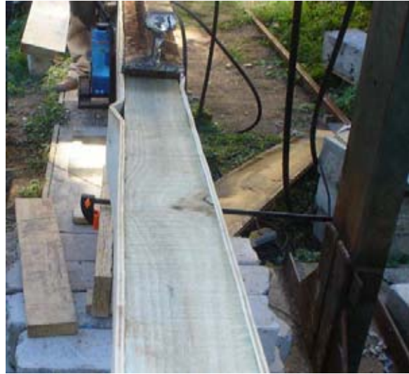
Viga 5 (VC 5,2): (Falla producida por el desprendimiento del contrachapado)
