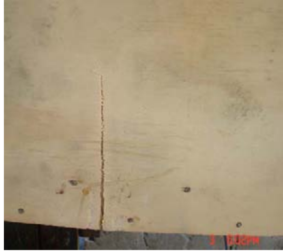
Viga 1 (VC 5,2): (Falla contrachapado en el tercio central de la luz de ensayo)
