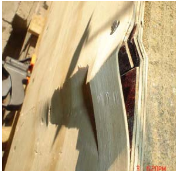
Viga 4 (VC 9): (Falla del contrachapado en el tercio central de la luz de ensayo)
