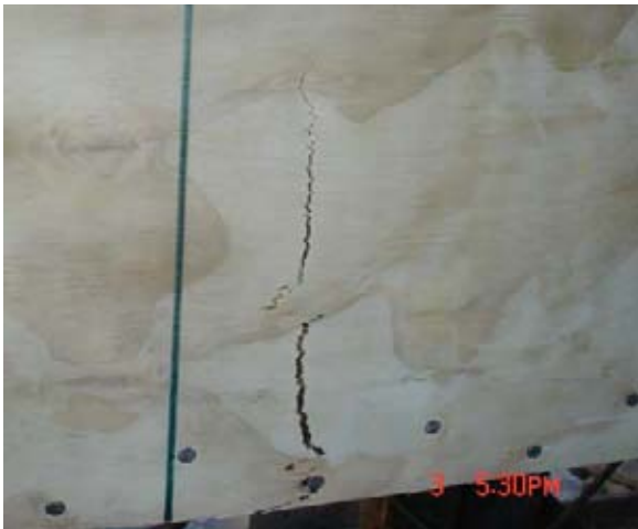
Viga 7 (VC 9): (Falla del contrachapado en el tercio central de la luz de ensayo)
