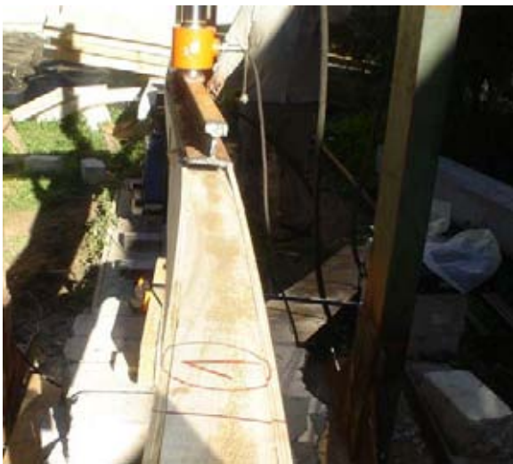
Viga 1 (VC 9): (Falla por pandeo y fractura del contrachapado)
