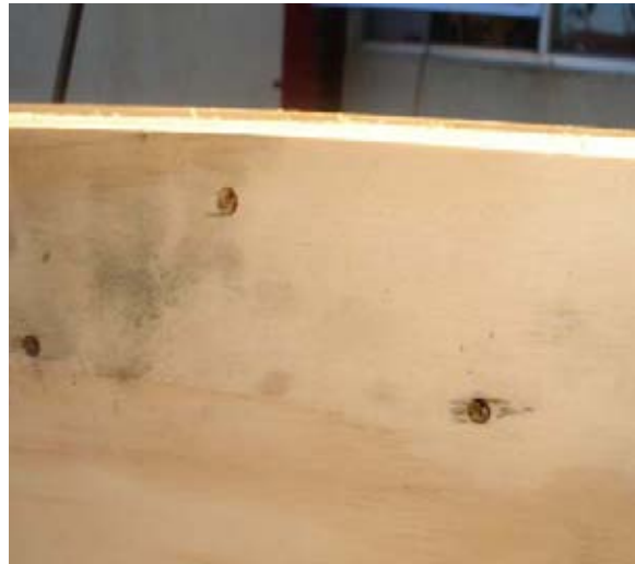
Viga 2 (VC 5,2): (Falla producida por el desprendimiento del contrachapado)
