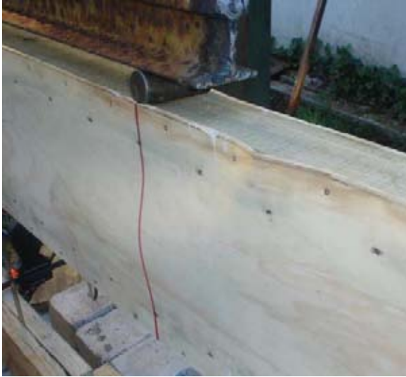
Viga 5 (VC 5,2): (Falla producida por el desprendimiento del contrachapado)
