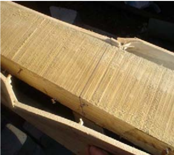
Viga 2 (VC 5,2): (Falla producida por el desprendimiento del contrachapado)
