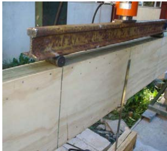
Viga 4 (VC 5,2): (Falla contrachapado en el tercio central de la luz de ensayo)
