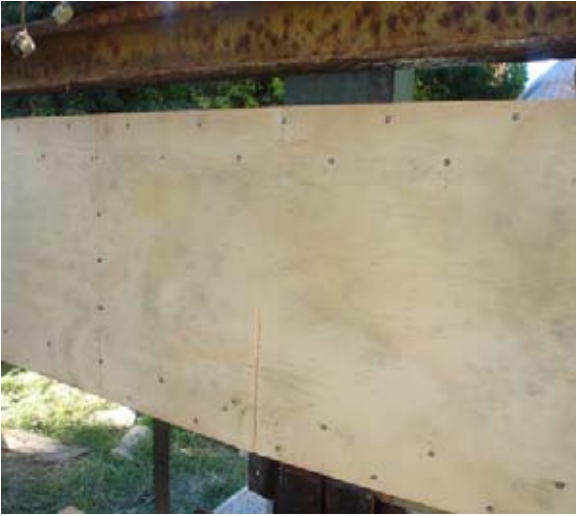
Viga 1 (VC 5,2): (Falla contrachapado en el tercio central de la luz de ensayo)
