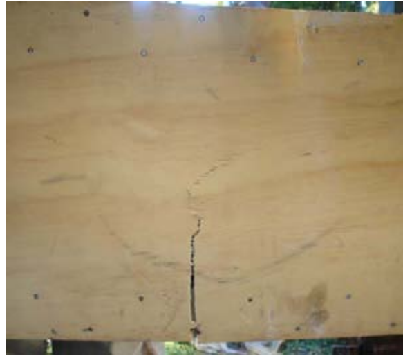
Viga 3 (VC 5,2): (Falla contrachapado en el tercio central de la luz de ensayo)
