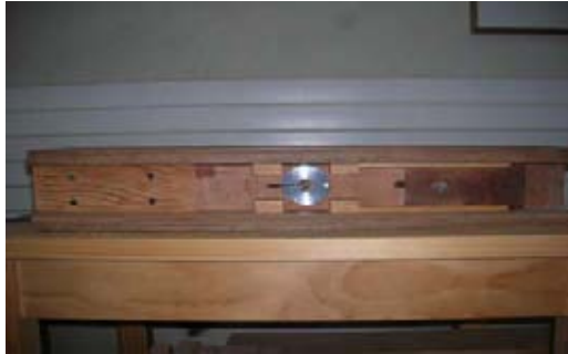
Figura 8: Porta probetas con sensor piezoeléctrico en el centro
