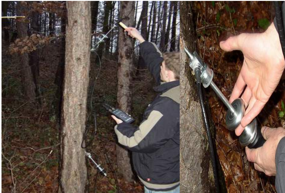
Figura 2. Medición del módulo de elasticidad en árboles en pie.
