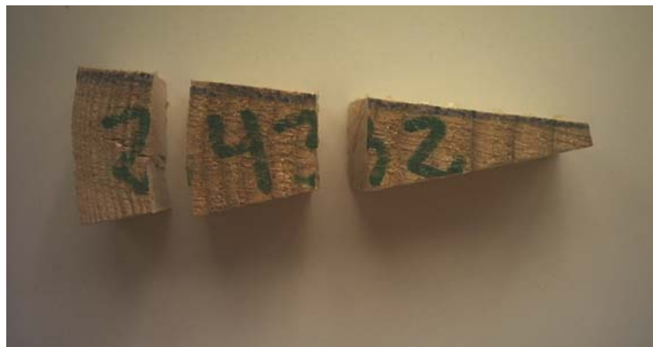
Figura 7. Cuña seccionada en tres probetas.
