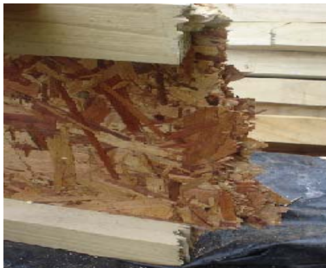
Figura 14. Fractura total OSB en dirección perpendicular a las alas.
