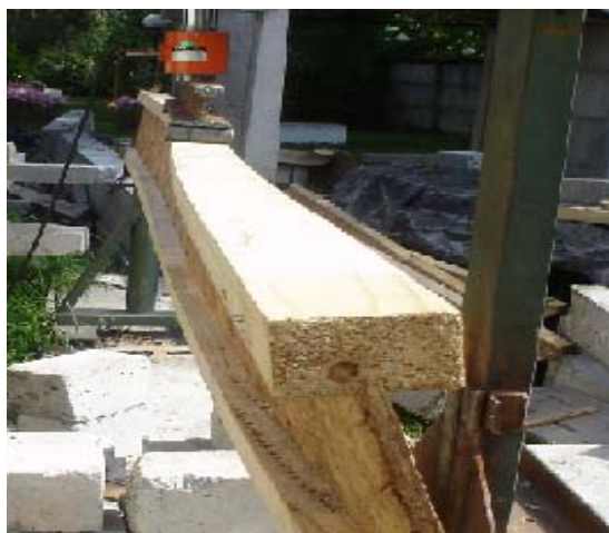
Figura 17. Falla Tipo F Pandeo, con sistema de aplicación de carga.
