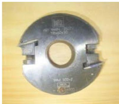
Figura 8. Cabezal hidrocentrante de 2 cuchillos Z=2
