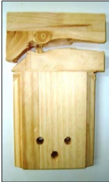
Figura 3. Imagen representativa de falla pieza vertical
