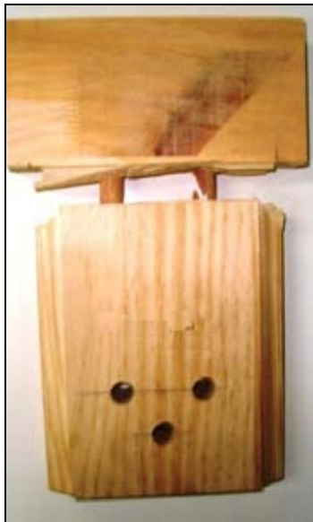
Figura 5. Imagen representativa de deslizamiento en 1 tarugo + 1 cortado
