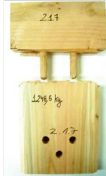
Figura 4. Imagen representativa de deslizamiento en los 2 tarugos
