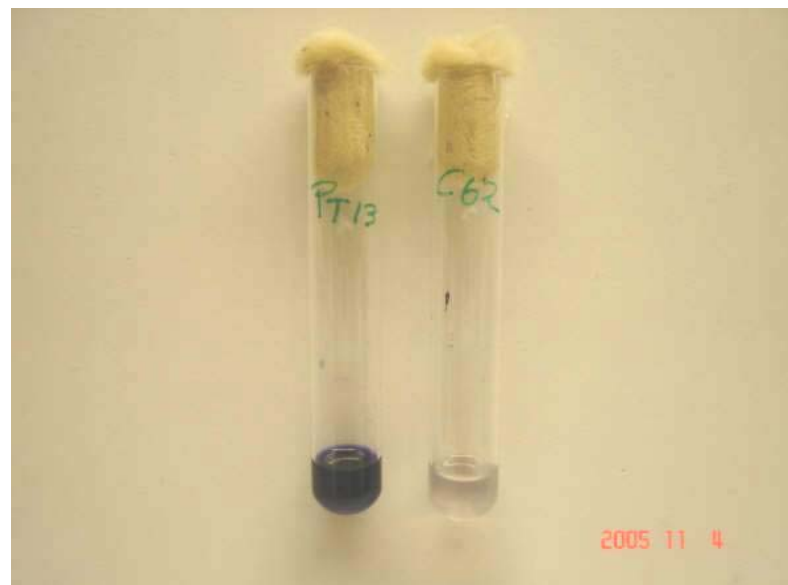
Figura 2. Hidrólisis del hipurato. El tubo del lado izquierdo muestra una reacción positiva y el tubo del lado derecho y una reacción negativa.
