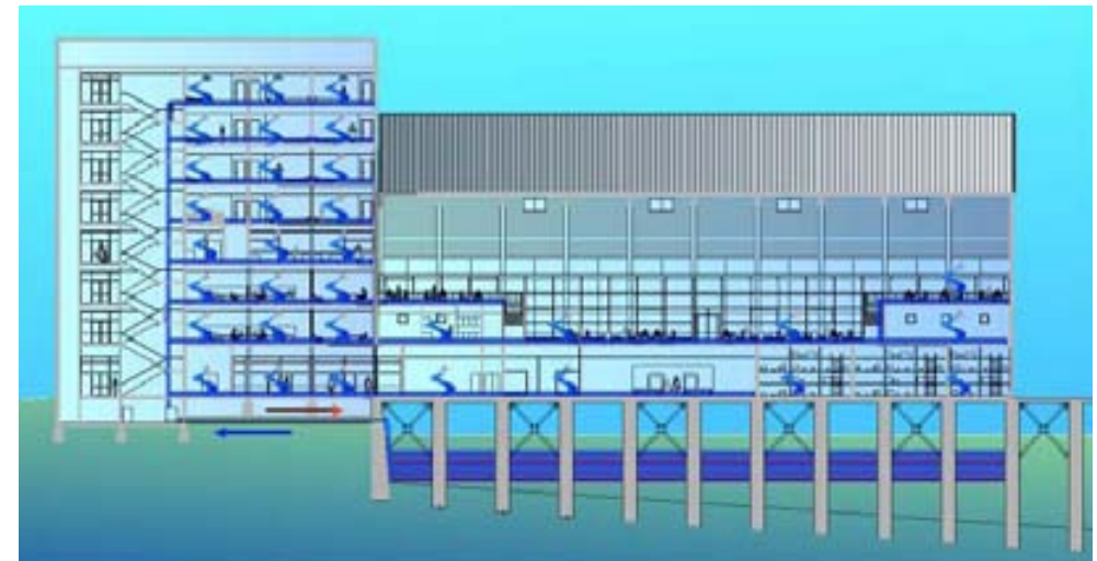
Sistema de refrigeración por geotermia en meses de verano
