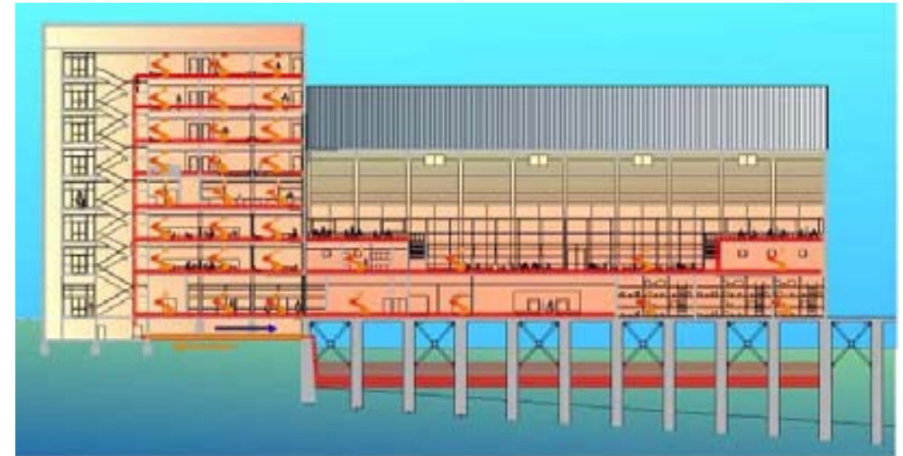
Sistema de calefacción por geotermia en meses fríos
