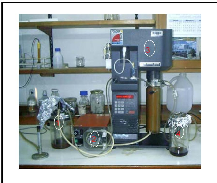
**Figura 19. Obtención del superconcentrado celular a través del sistema Spintrex™**
