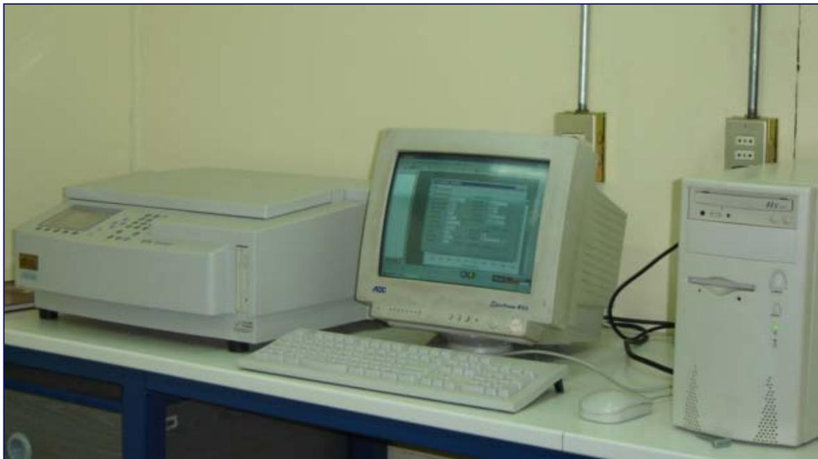
**Figura 7.-** Espectrofotómetro UNICAM (serie UV 500) usado en la identificación de pigmentos foliares, tales como: clorofila, carotenos y flavonoides.
