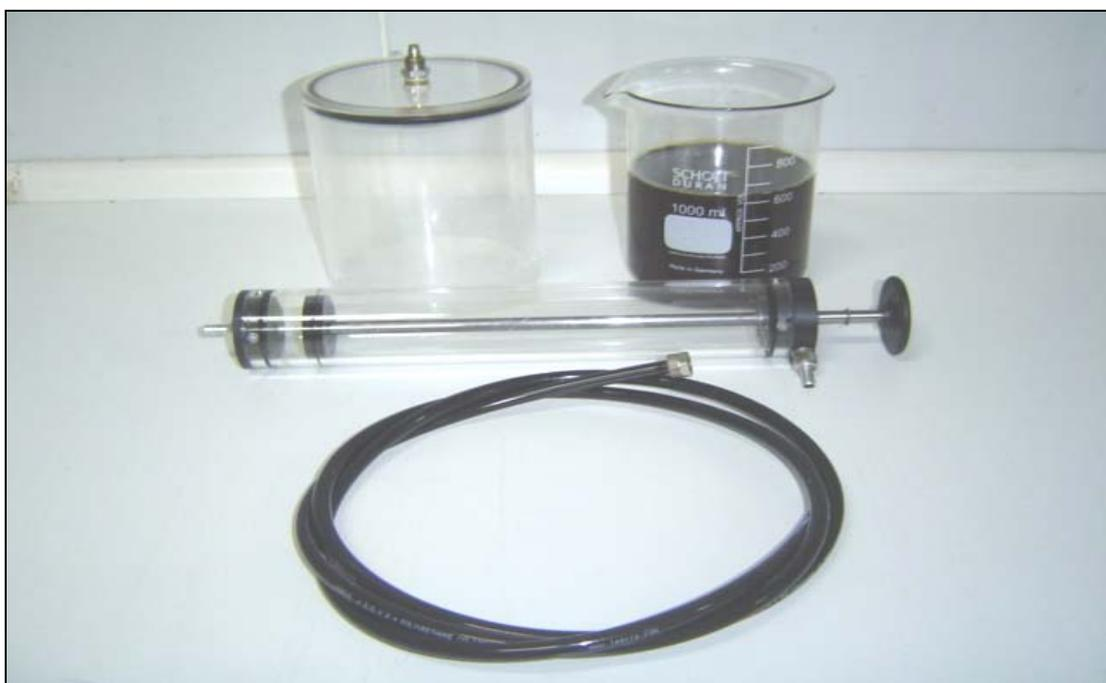
**FIGURA 16. Aceitador de laboratorio con sistema de vacío**
