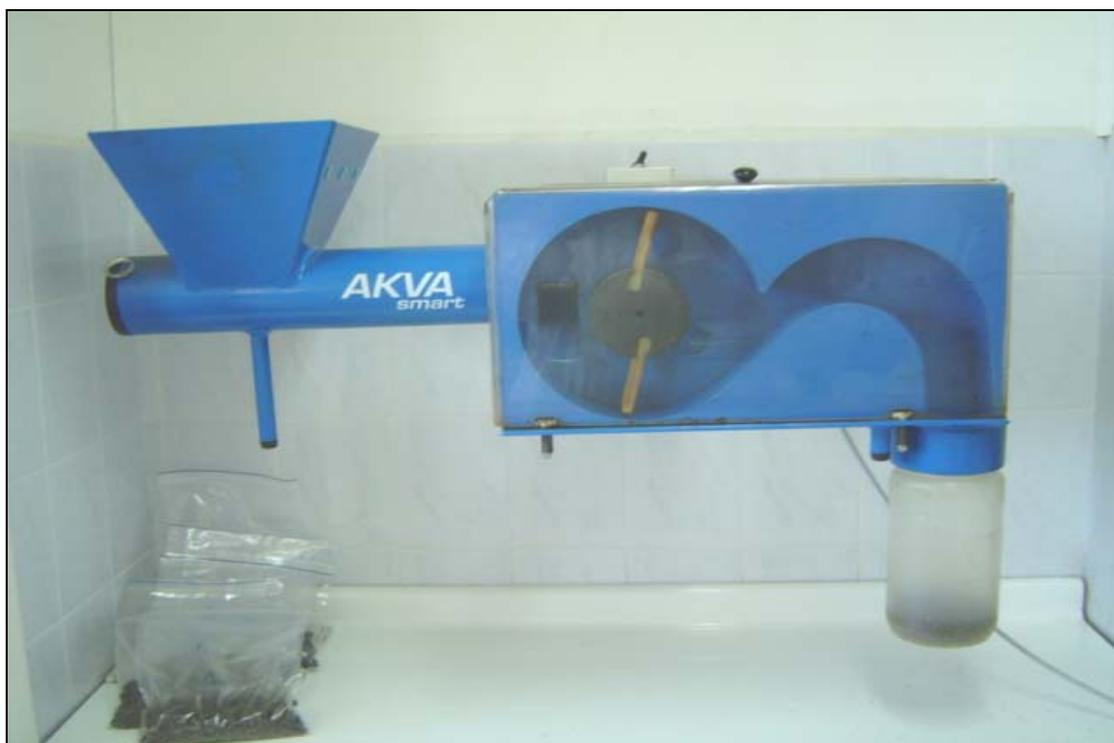
**FIGURA 18.** Equipo de medición de durabilidad Akvasmart.
