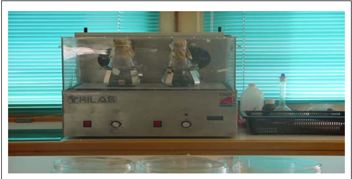
FIGURA 5 Equipo de agitación continua utilizado para homogenizar los propágulos Helminthosporium solani previa obtención del inóculo.
