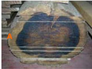
**Figura 11.** Sección transversal de troza de aramo australiano La letra A identifica a la albura y la parte oscura al duramen.
