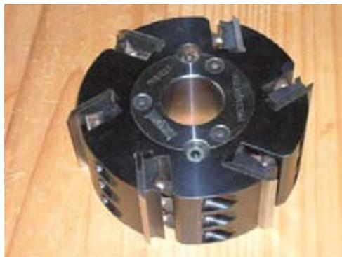
**Figura 16.** Cabezal hidrocentrante de 6 cuchillos Z=6
