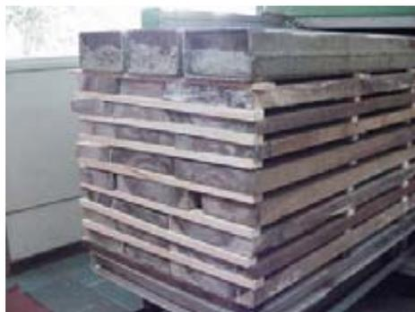
**Figura 10.** Aromo australiano a la entrada del secador
