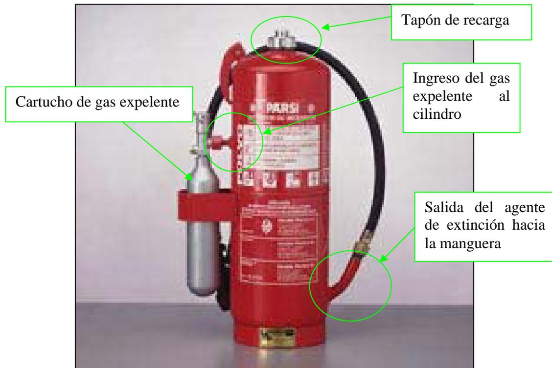
Figura 15.- Extintores de Presurización por Cartucho de Gas
