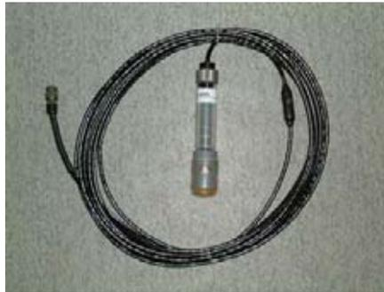
Fig.20 Sensor de Niveles de Oxígeno Disuelto en el Agua
