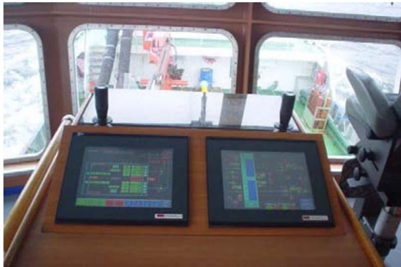
Fig.54 Panel de Sistema de Monitoreo y Calidad del Agua (Izquierda) y Panel de Carga y Descarga (Derecha) en el Puente de Gobierno
