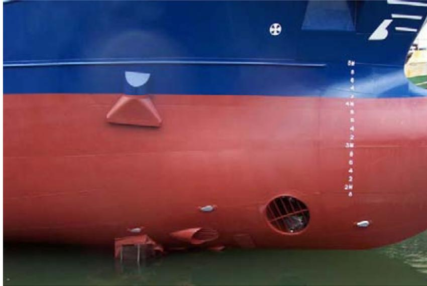
Descarga al costado – Válvulas de fondo – Empujadores Transversales
