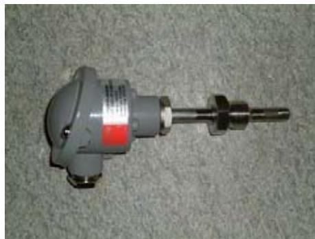
Fig.22 Sensor de Temperatura en el Agua
