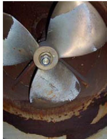
Zona de cofferdam interior de bodega (izquierda) – Succión de Thruster Pump en cofferdam interior
