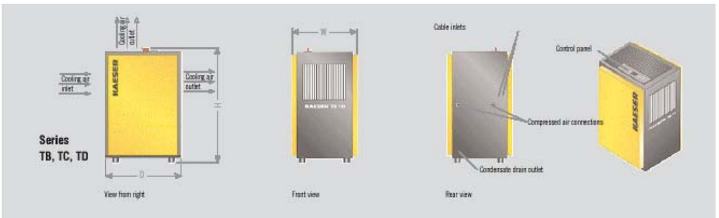
Fig.6 Vista frontal, lateral y trasera de secador de aire Kaeser, para modelos TB-TC-TD
