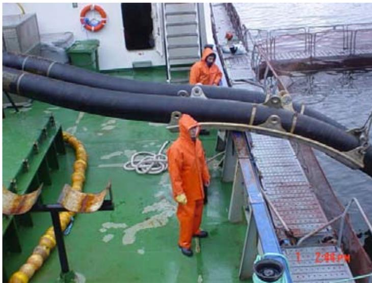
Fig.56 Imagen muestra el problema que se ocasiona en la amura, con el roce de la base de sujeción de las yomas
