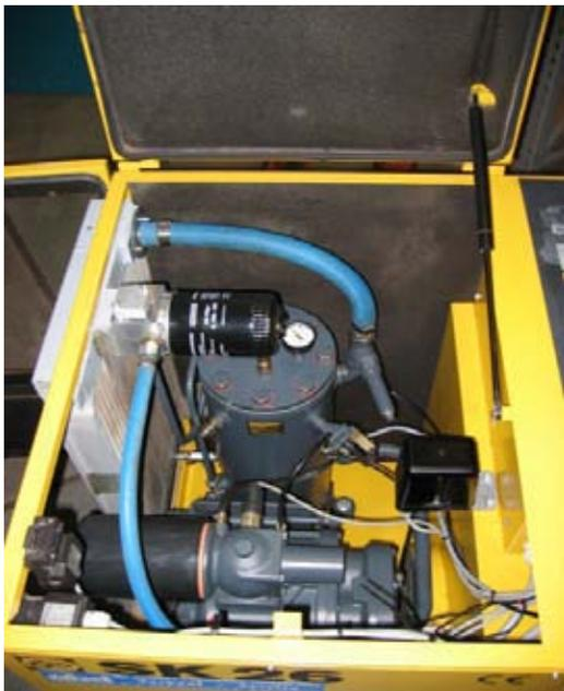
Fig. 3 Vista interior de compresor de aire
