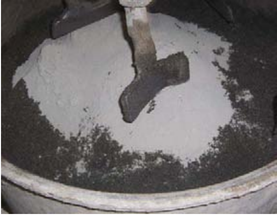
Betonera con arena y cemento
