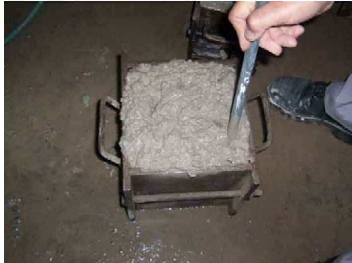
Compactación con varilla pisón
