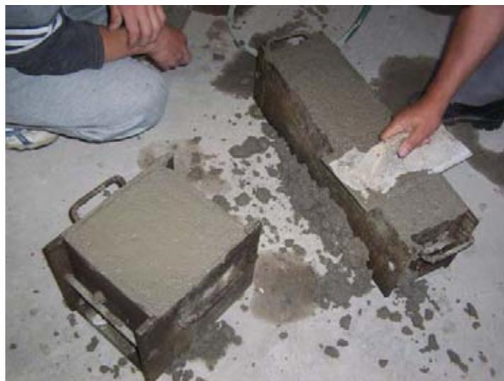
Terminación probetas mediante allanado.
