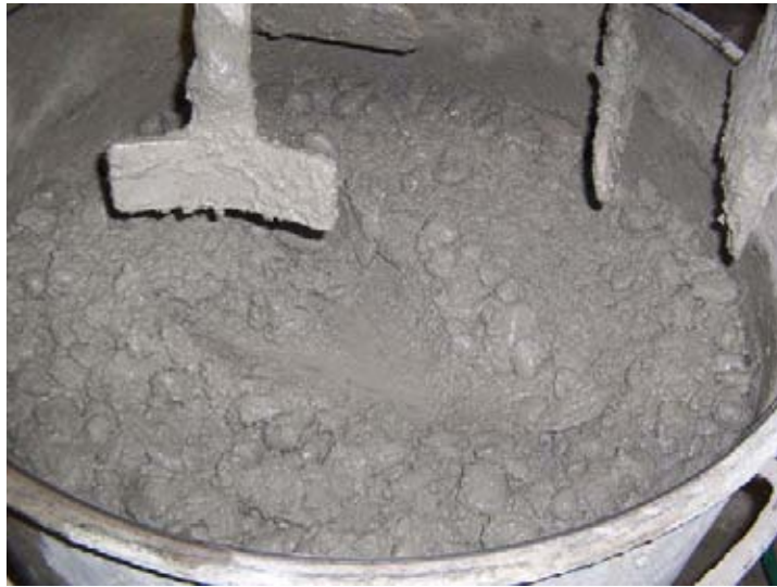
Betonera con arena, cemento, grava y agua.
