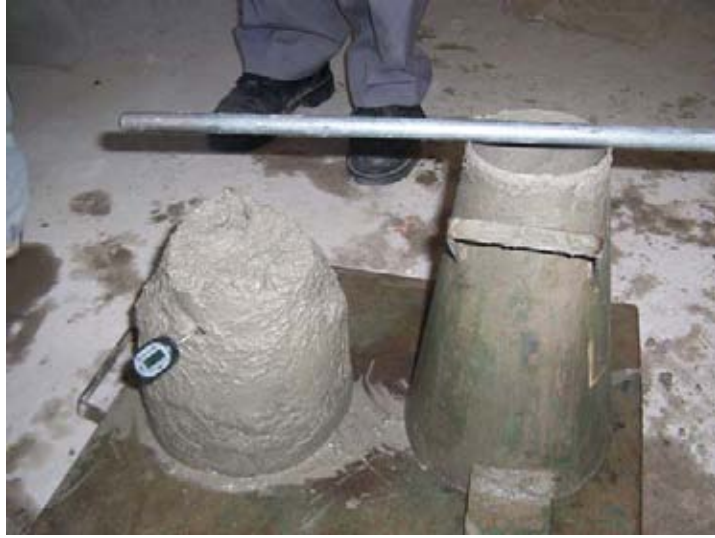
Proceso de medición temperatura
