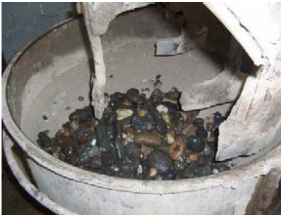
Betonera con arena, cemento y grava
