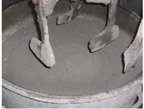
Betonera con arena y cemento
