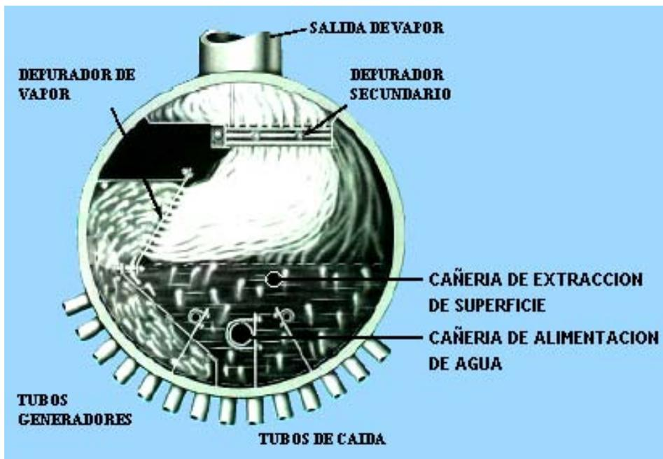
**Colector de Vapor de una Caldera Acuotubular**
