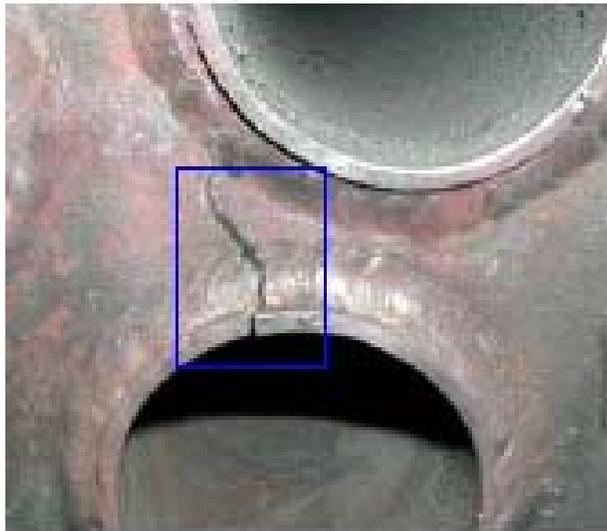
**Fractura en Colector de Vapor (Placa de Tubos Generadores)**
