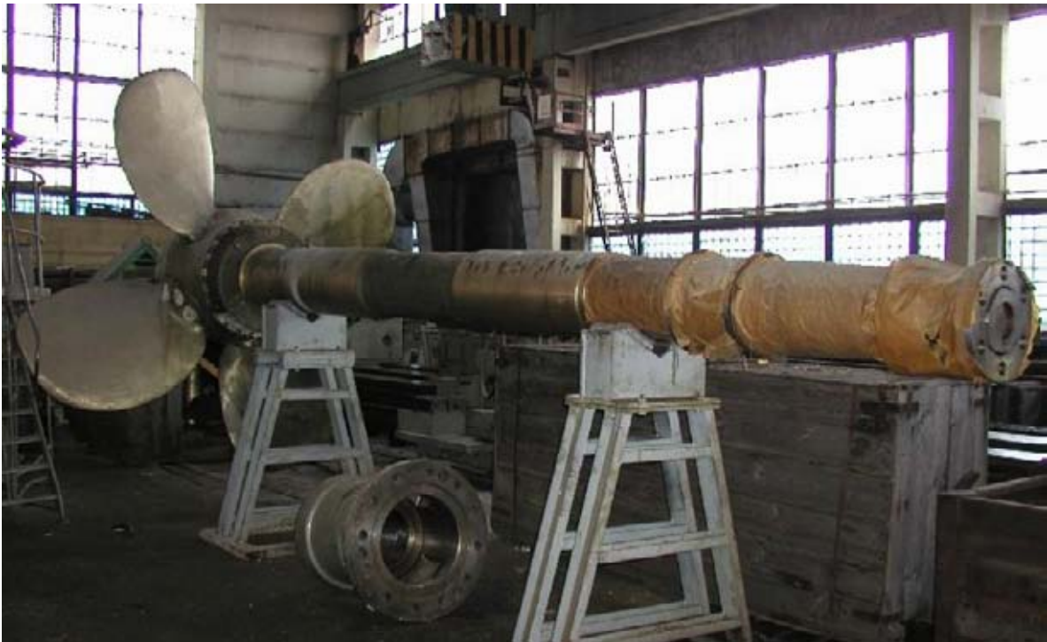
Figura 1.3.4 Fotografía que muestra las camisas de bronce en el eje propulsor.
