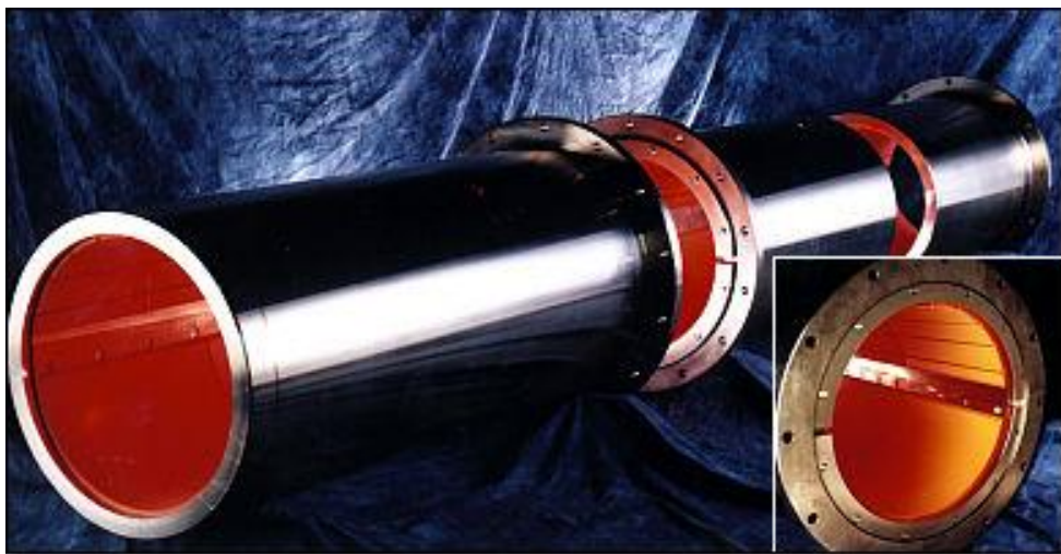
Figura 1.3.5 Fotografía de montaje de una bocina de material de Thordon.
