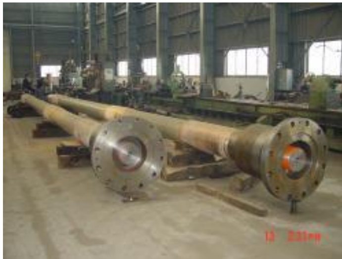
Figura 1.2.4 Fotografía que muestra las caras de acoplamiento de los ejes.
