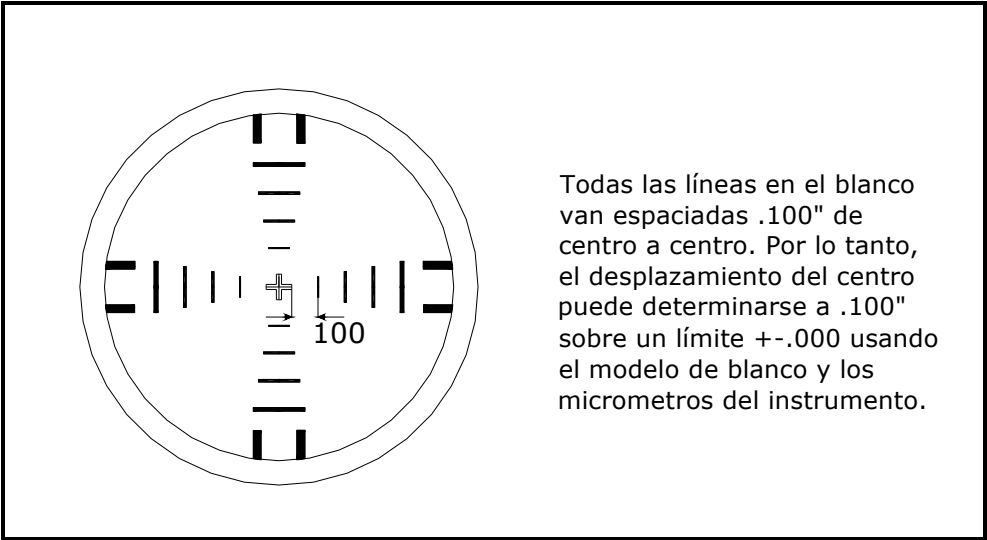
Figura 4.1.3.B Modelo de un blanco de un micrómetro óptico.
