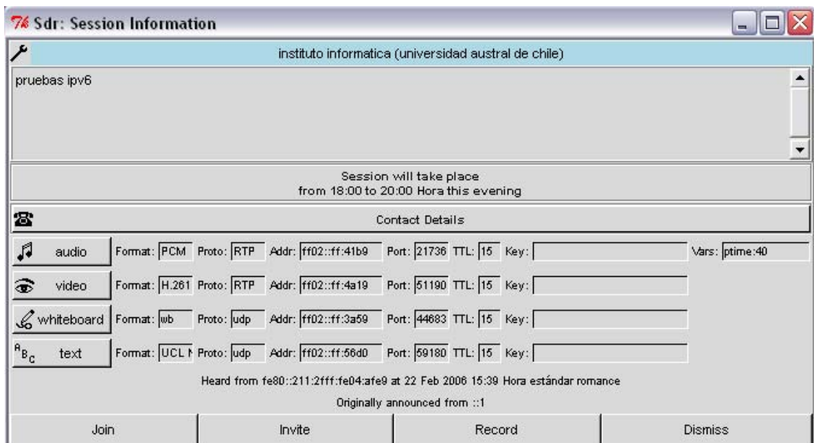
Figura IV-5: Muestra la pantalla donde se pueden configurar las herramientas de RAT, VIC, NTE y WBD.
