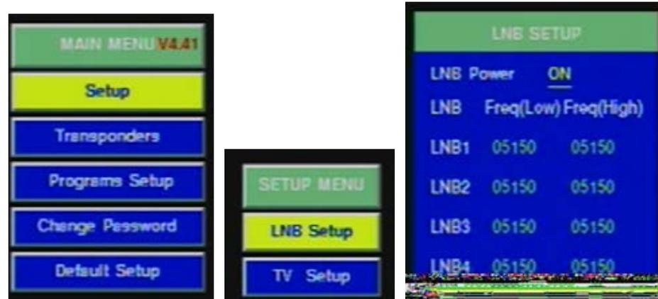
Figura 7. 4: Configuración frecuencia de LNB en el receptor.
