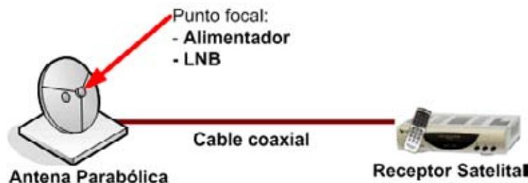
Figura 2. 3: Esquema general de un sistema de recepción de TV satelital.
