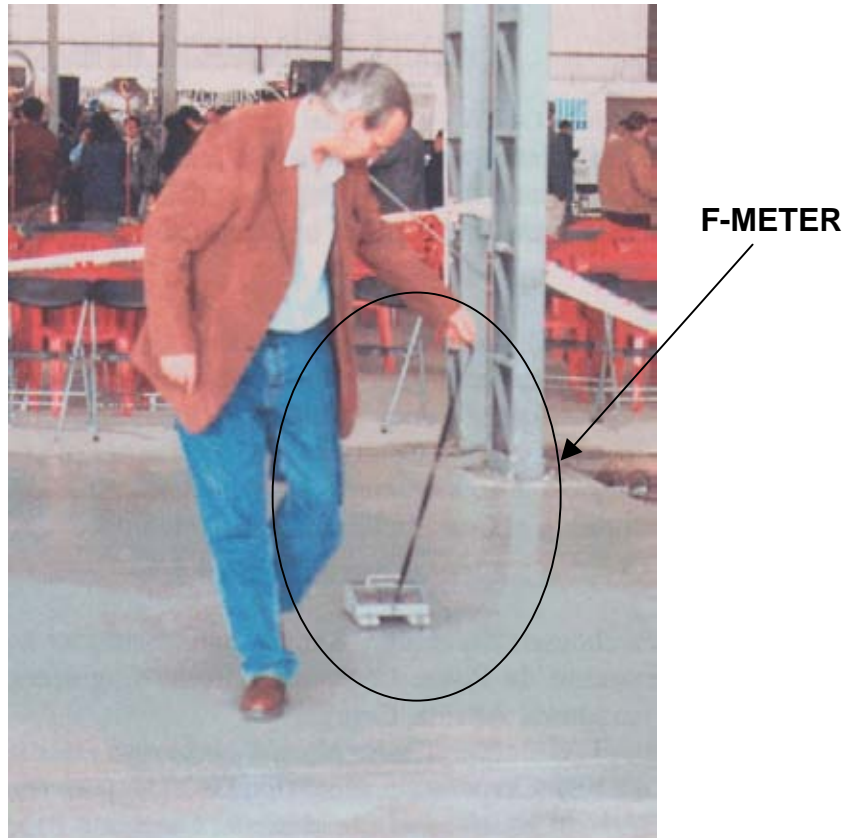
Verificación de Planeidad y Horizontalidad de una losa por medio del F Meter
