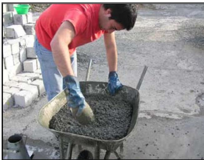
Fotografía N°7 Hormigón de prueba N°3, H70/ HP-3.
