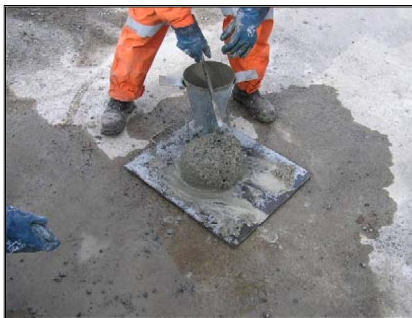
Fotografía N°6 Ensayo del cono de Abrams, H70/ HP-2.
