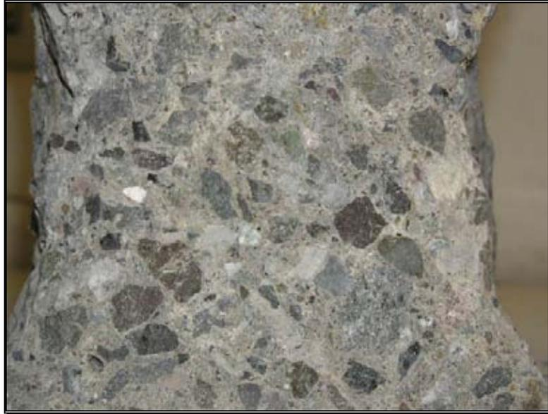
*Fotografía N°16 Probeta ensayada, Hormigón de Prueba N°2 "H-70"*
