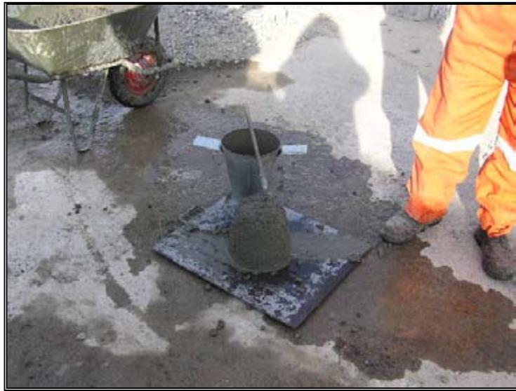
*Fotografía N°8 Ensayo del cono de Abrams, H70/ HP-3.*
