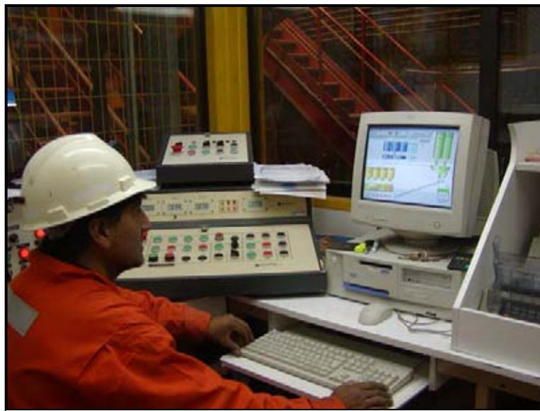
*Fotografía N°20 Monitoreo del proceso de fabricación del hormigón.*
