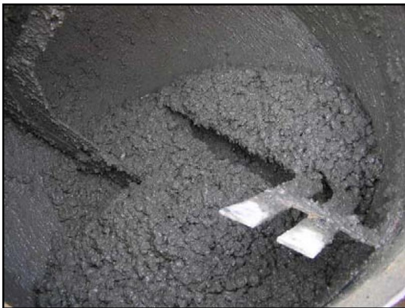
*Fotografía N°3 Mezclado de hormigón con microsílíce, H70/ HP-3.*
