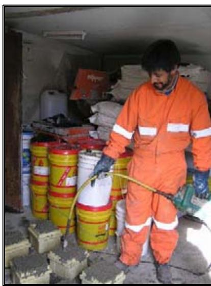
Fotografía N°4 Vibrado de probetas de hormigón.
