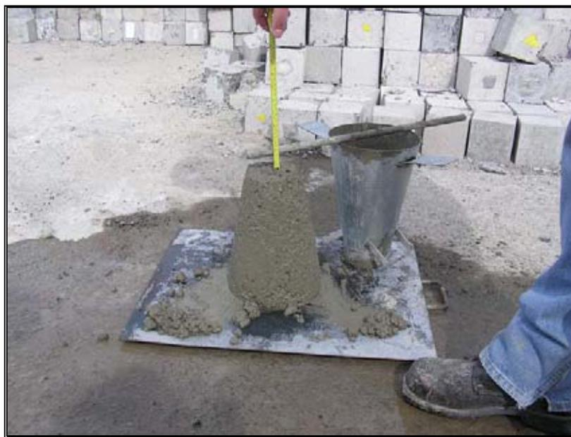
Fotografía N°5 Ensayo del cono de Abrams, H70/ HP-1.
