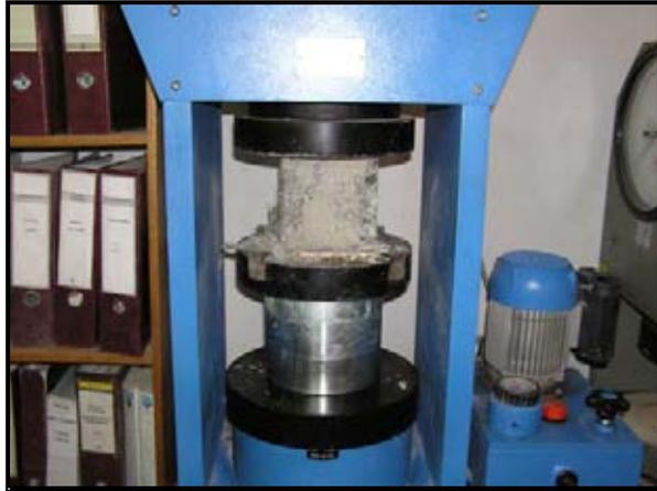
*Fotografía N°11 Ensayo de resistencia a la compresión.*
