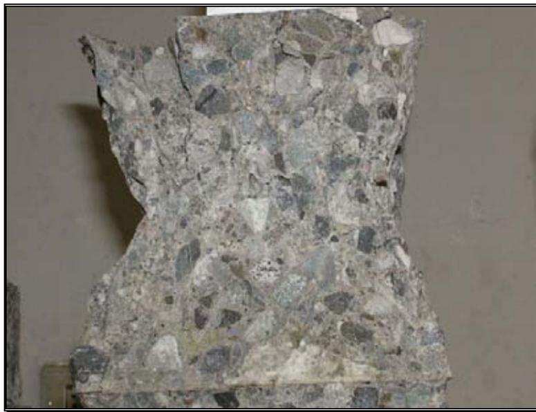
*Fotografía N°15 Probeta ensayada, Hormigón de Prueba N°2 "H-70"*
