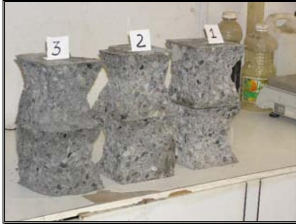
*Fotografía N°12 Probetas de hormigón ensayadas.*
