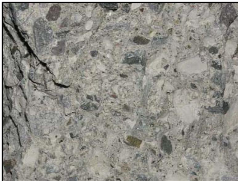
*Fotografía N°14 Acercamiento a probeta de Hormigón Patrón "H-70"*
