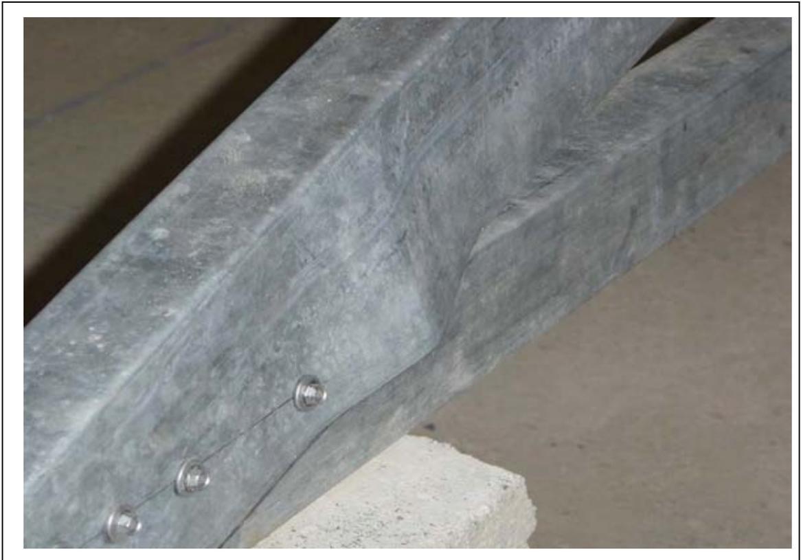
Figura (8.3): falla visible momentos antes del colapso
