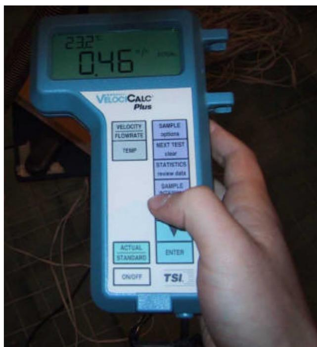
**Ilustración 5 Panel del Termoanemómetro TSI.**
