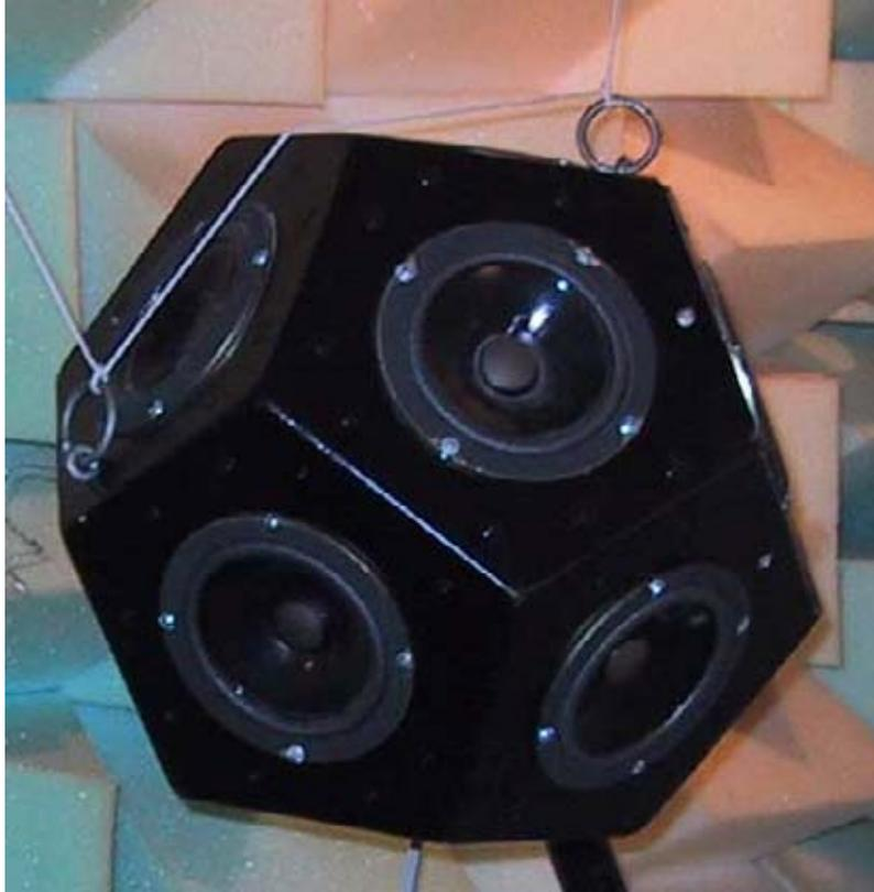
**Ilustración 7 Fuente Omnidireccional**
