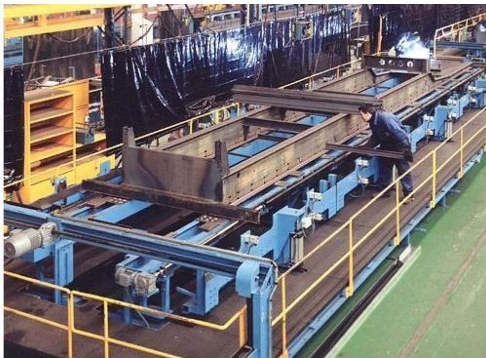
Figura 22 – Imagen de plena fabricación de SR., en donde se ve claramente a un operador ubicar un travesaño, por cortes ubicados en las vigas maestras del SR.
