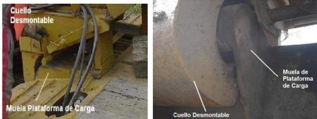
Figura 13 – Muela acoplamiento plataforma de carga.
