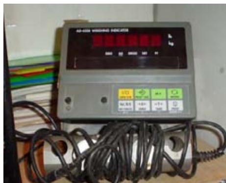
Figura 7.11. Celda de carga y medidor electrónico de carga
