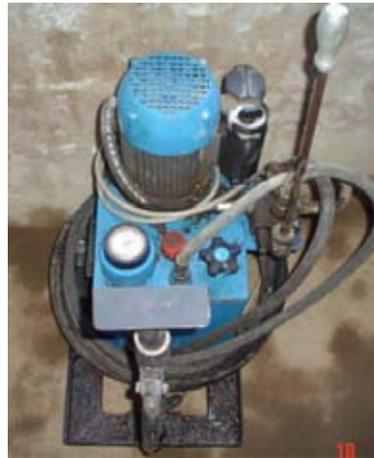
Figura 7.12. Bomba hidráulica
