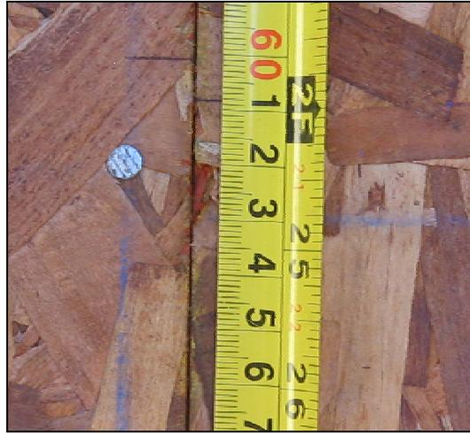
Figura 7.6 Desplazamiento relativo de las placas de OSB panel N°2.
