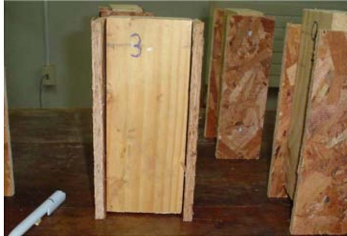
Figura 5.5. Estado de la probeta después de ser ensayada.
