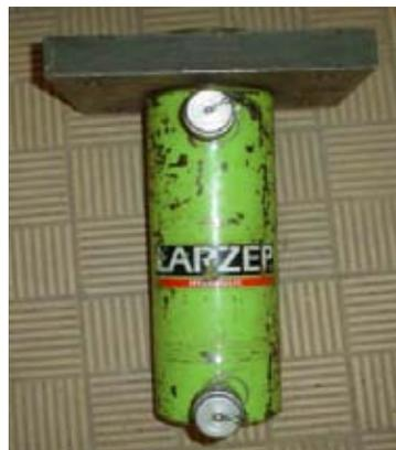
Figura 7.10. Pistón hidráulico.
