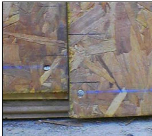
Figura 7.7. Desplazamiento relativo de las placas de OSB al momento de alcanzar la carga ultima.
