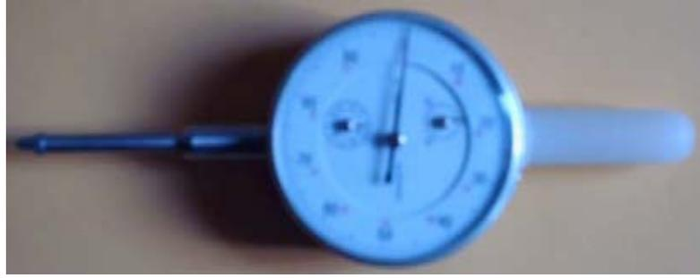
Fig. 3-9: Tipo de Dial usado para medir deformación.
