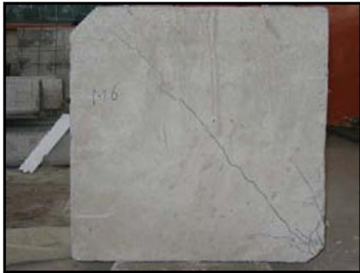
**Fig. 5.17** Vista murete N° 6. Se aprecian la línea de corte transversal, y las líneas de corte de las cuñas en los apoyos, producto del ensayo de carga.
