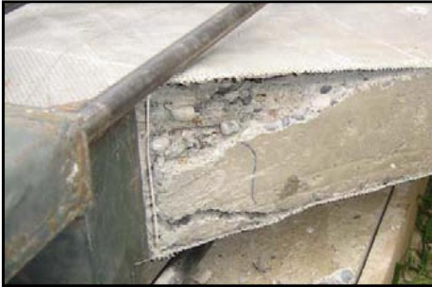
**Fig. 5.28** Vista posterior murete N° 5. Se puede observar que la falla ocurrió, no por la adherencia del sistema de refuerzo, sino debido al colapso del substrato de hormigón.
