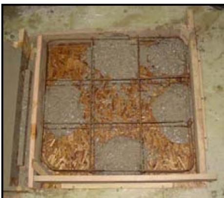
**Fig. 5.6** Hormigonado Probetas.
