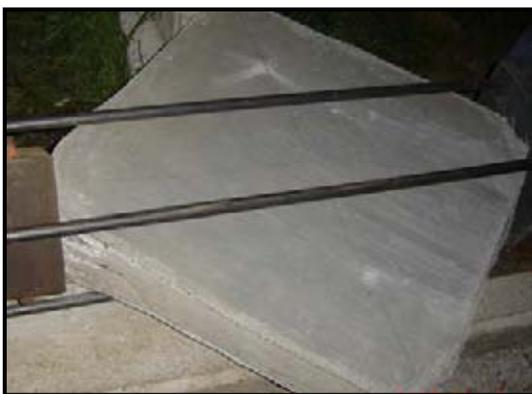
**Fig. 5.29** Vista murete N° 6. No se observan grietas visibles, una vez removido el deformimetro.
