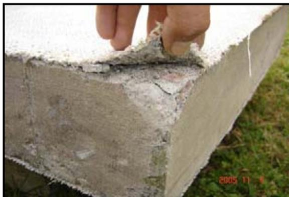
**Fig. 5.21** Vista apoyo contrario murete N° 1. Se aprecia la delaminación ocurrida en el apoyo producto de a cuña metálica.
