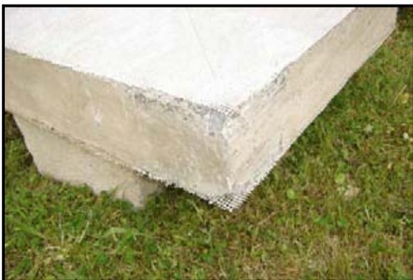
**Fig. 5.20** Vista apoyo murete N° 1. Tal y como se observa, el apoyo no presenta daños después del ciclo de carga.
