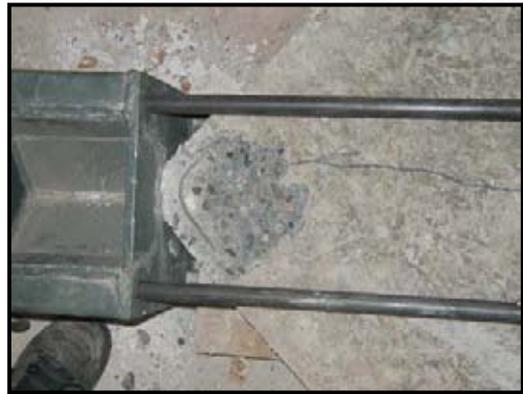
**Fig. 5.18** Vista murete N° 6. Se aprecia la falla por aplastamiento del apoyo.
