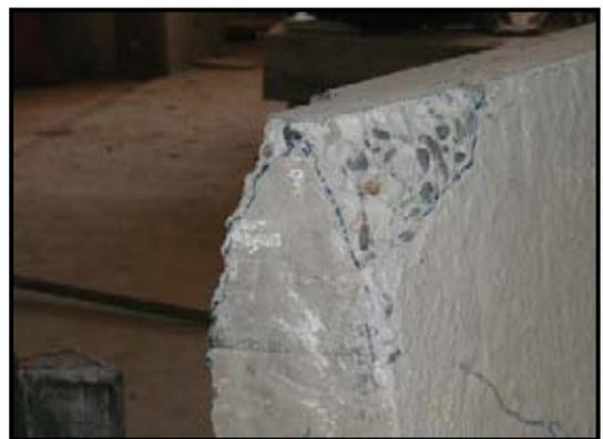
**Fig. 5.16** Vista apoyo murete N° 5. Se aprecian desprendimientos menores en las aristas del murete.
