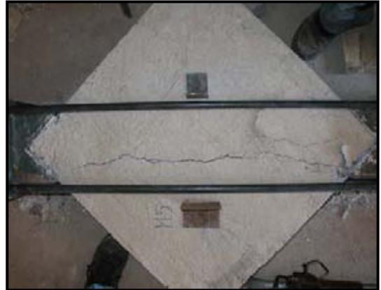
**Fig. 5.14** Vista superior murete N° 5, donde se aprecian los daños resultantes de la aplicación de la carga.
