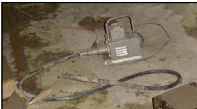
**Fig. 5.3** *Vibrador.*
