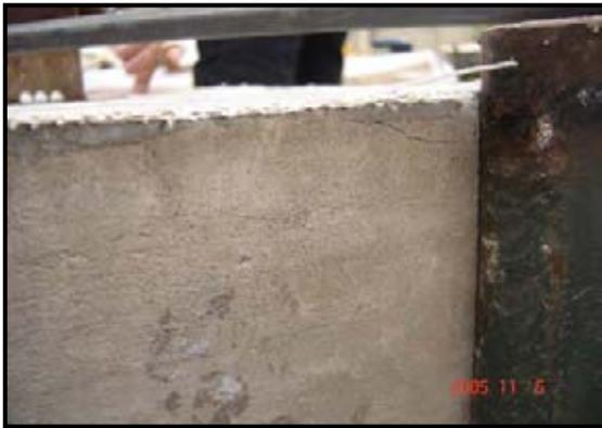
**Fig. 5.22** Vista apoyo murete N° 2. Solo se observa una pequeña fisura de carácter local en el apoyo.
