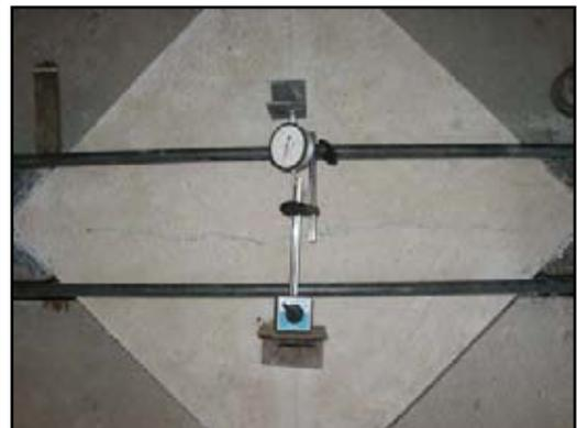
**Fig. 5.13** Única fisura visible en murete Nº 4, la cual no se percibe a simple vista al remover la carga.
