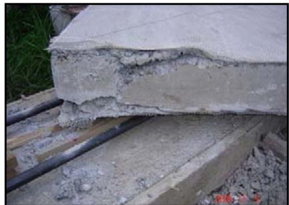
**Fig. 5.25** Vista apoyo murete N° 3. Se observa la cuña formada en el apoyo, y su desplazamiento hacia un costado del murete.
