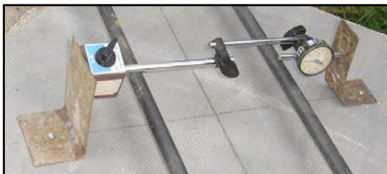
Fig. 5.11 Deformímetro de dial, durante el ensayo.
