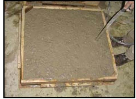
**Fig. 5.7** Vibrado mezcla.
