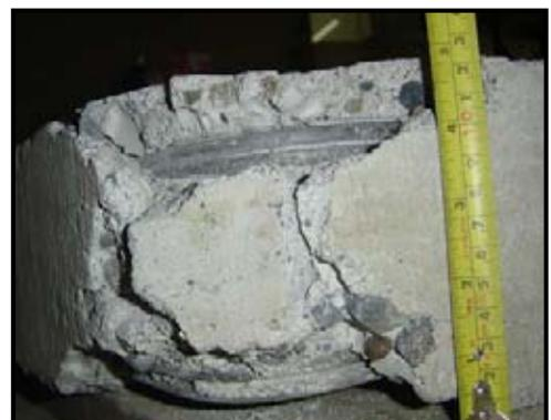
**Fig. 5.19** Vista apoyo murete N° 6. Se aprecian las enfierraduras principales, así como, el material desprendido entre ellas.
