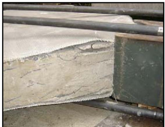
**Fig. 5.27** Vista murete N° 5. La falla se presento en el apoyo reparado con mortero de cemento y Colma Fix® 32.
