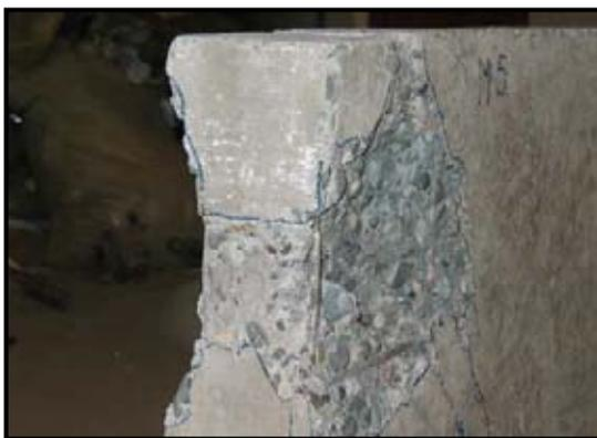
**Fig. 5.15** Vista apoyo murete N° 5, donde se aprecian las enfierraduras, y la cuña formada por la carga aplicada.
