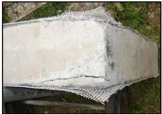
**Fig. 5.26** Vista apoyo murete N° 4. Se observa solo una falla de tipo local en apoyo, atribuible a la cuña metálica de carga.
