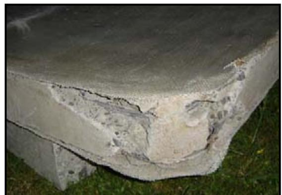
**Fig. 5.30** Vista apoyo murete N° 5. Se observa el aplastamiento del hormigón debido a la cuña formada en el apoyo.
