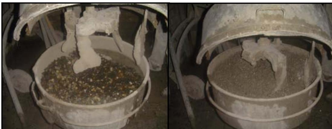
**Fig. 5.2** *Betonera, con capacidad de 65 lts.*
