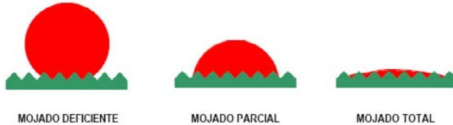
**FIGURA N°11** Ejemplo de diferentes tipos de mojados
