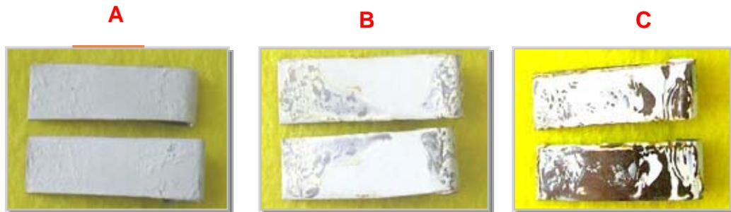
**FIGURA N°35** Probetas de pre-ensayo con adhesivo instantáneo “la gotita”
