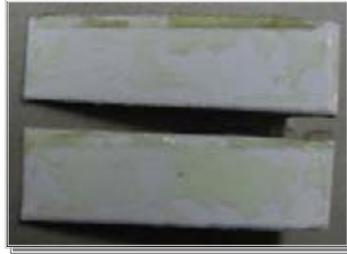
**FIGURA N°34** Probeta con adhesivo epóxico de endurecimiento rápido
