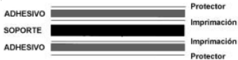
**FIGURA N°9** Esquema de una cinta de doble cara
