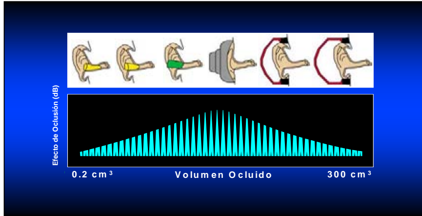
Figura 9 - Muestra el efecto de oclusión y la relación con el ajuste y el tipo de protector auditivo. El efecto es mínimo cuando el protector tipo tapón es insertado profundamente y crece a medida que el protector es retirado. En el caso de orejeras el efecto de oclusión es menor para copas con volúmenes grandes.
