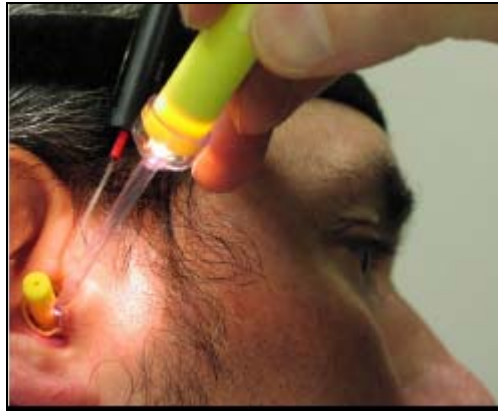
Figura 16- La sonda se inserta entre el tapón auditivo y las paredes del conducto auditivo. Con este tipo de montaje hay que tener cuidado con las fugas (mal ajuste de la sonda), las cuales pueden reducir ostensiblemente el rendimiento acústico del protector auditivo.
