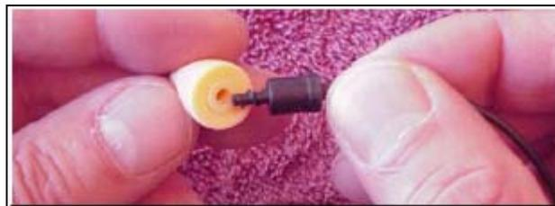
**Figura 15** - Se muestra como se coloca el micrófono dentro del protector auditivo. Éste tipo de montaje se ha usado exitosamente para el monitoreo de exposición a ruido de un trabajador.
