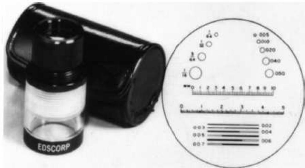
Fig. 4.01 Comparador para medir anchos de fisura ( Edmund Scientific Co.)
