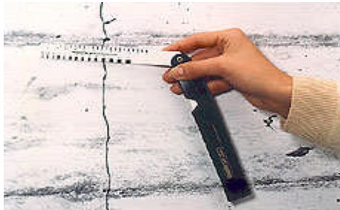
*Fig. 4.04 (Regla para medir fisuras)*
