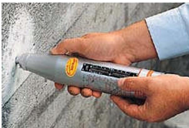
Fig.4.05 Martillo Schmidt (fuente: [www.proceq-usa.com](http://www.proceq-usa.com))
