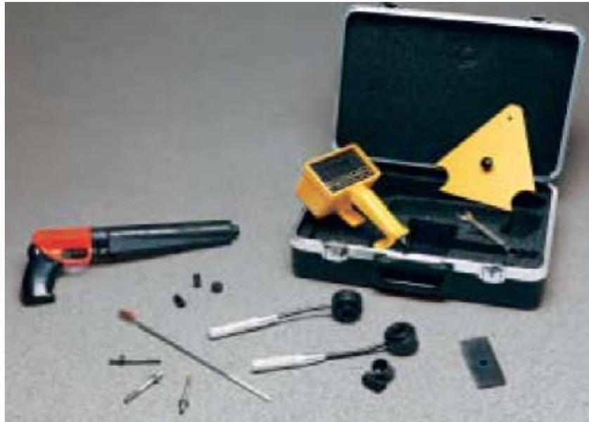
Fig. 4.06 Esclerómetro Windsor (Fuente:www. soiltest.com)
