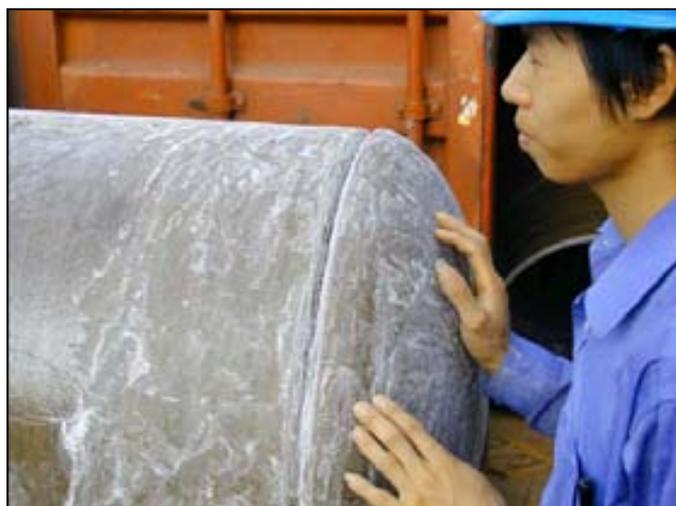
**Figura 4.22** Unión barrera de corrosión (Kvaerner, 2005)
