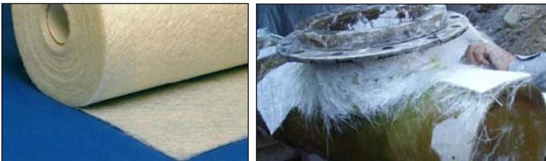
**Figura 2.13** Fibra de vidrio tipo Mat. Foto izquierda (Vetrotex, 2001), foto derecha (tomada por la autora)
