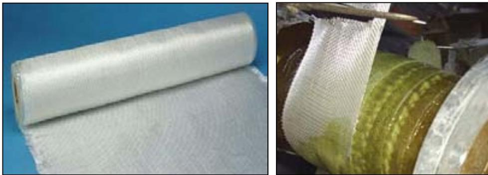
**Figura 2.17** Fibra de vidrio tipo Woven Roving. Foto izquierda (Vetrotex, 2001), foto derecha (tomada por la autora)
