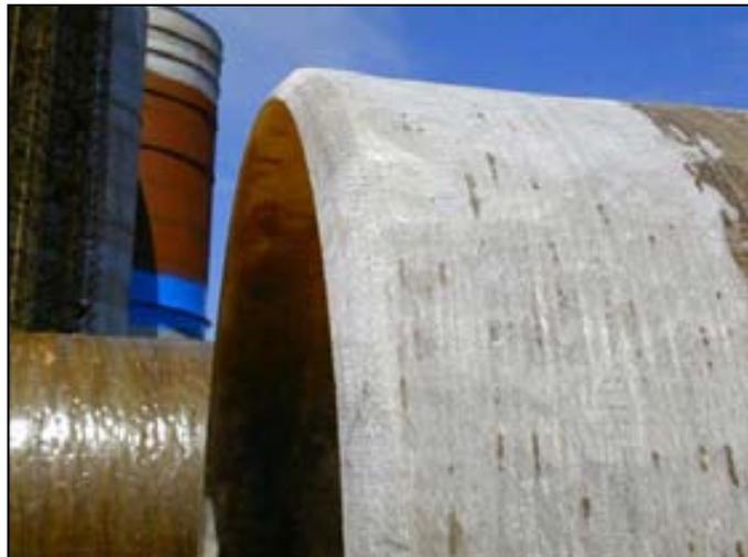
**Figura 4.13** Preparación de unión PN10 finalizada (Kvaerner, 2005)
