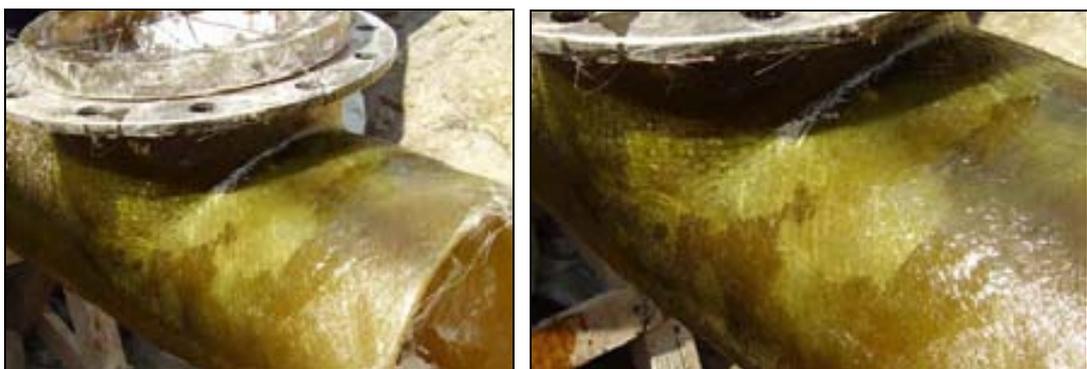
**Figura 3.4** Soldaduras fabricadas a exceso de temperatura (Fotos tomadas por la autora)
