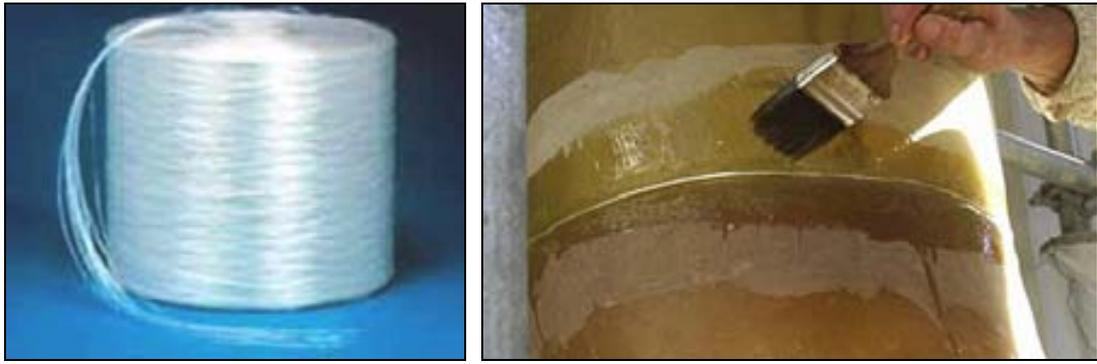
**Figura 2.15** Fibra de vidrio tipo Roving. Foto izquierda (Vetrotex, 2001), foto derecha (tomada por la autora)
