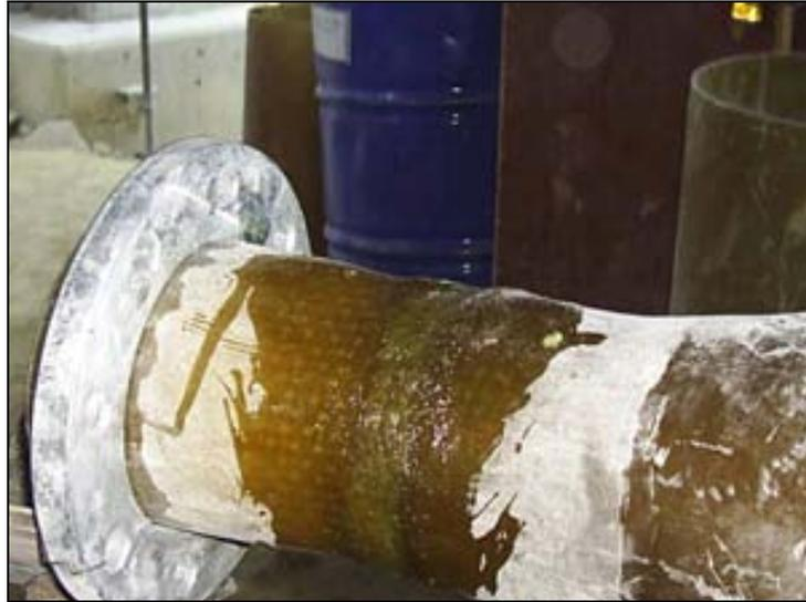
**Figura 5.62** Barrera de corrosión finalizada (Fotos tomadas por la autora)
