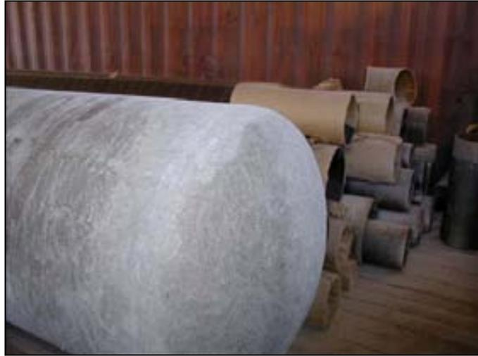
**Figura 4.30** Barrera de corrosión finalizada (Kvaerner, 2005).
