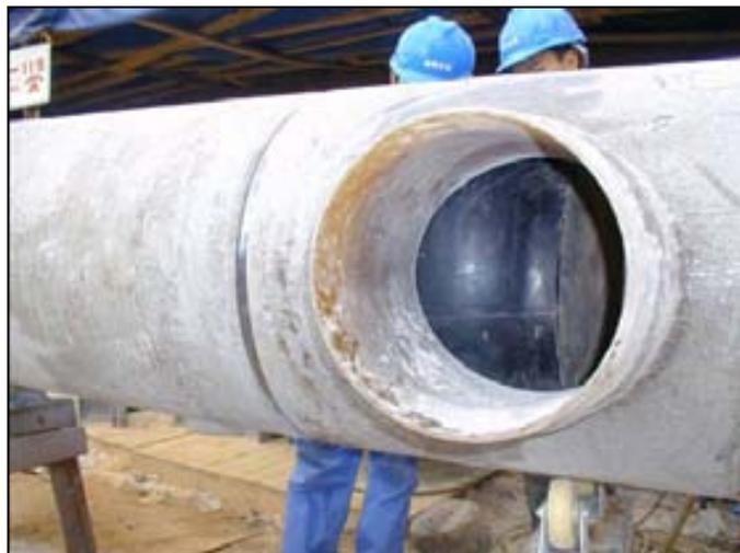
**Figura 4.21** Vista del molde a través del fitting (Kvaerner, 2005)
