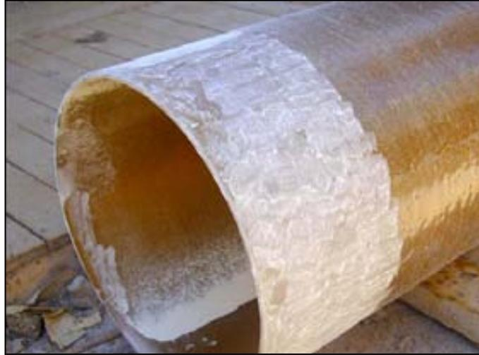
**Figura 4.12** Preparación de unión finalizada (Kvaerner, 2005)
