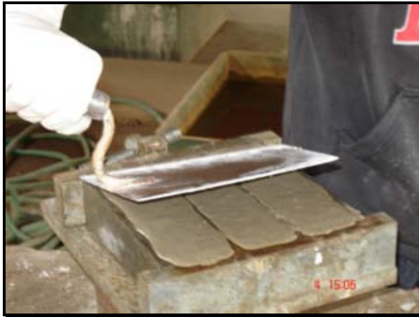
Imagen 3-11.- Enrasado de moldes Rilem
