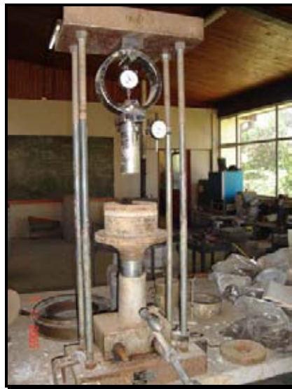
Imagen 3-14.- Prensa CBR para ensayos de Flexión
