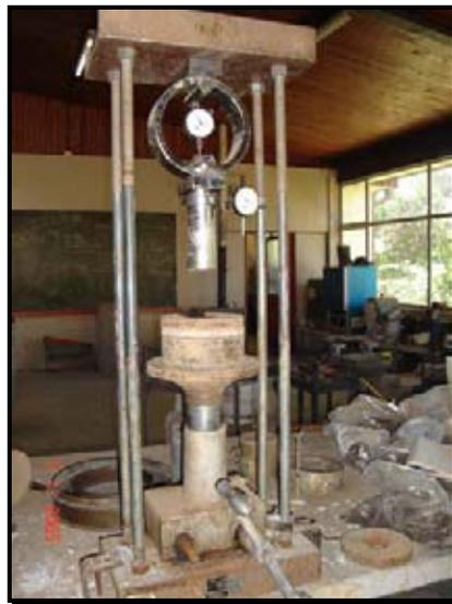
**Imagen 3-14.- Prensa CBR para ensayos de Flexión**
