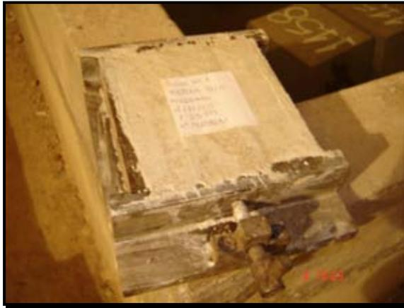
**Imagen 3-12.- Molde identificado y conservado en cámara húmeda**
