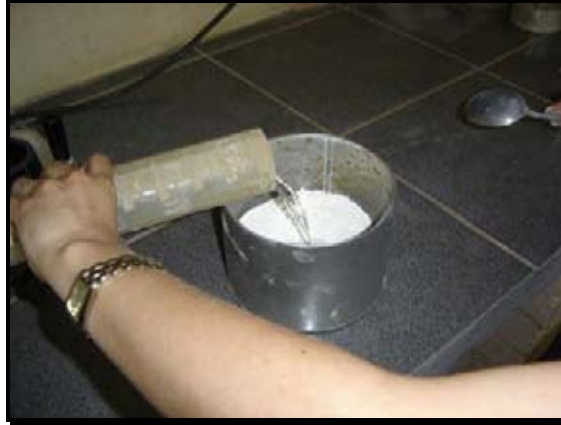
Imagen 3-1.- Preparación Pasta Normal de Cemento Blanco (1)
