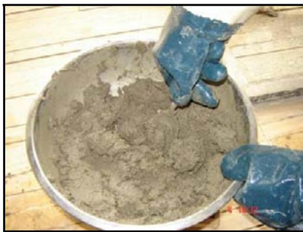
**Imagen 3-7.- Preparación de Mortero Normal (método mezclado manual)**
