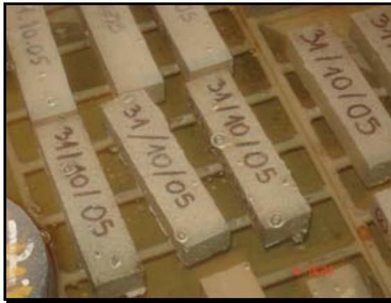
**Imagen 3-13.- Probetas desmoldadas y sumergidas en agua.**
