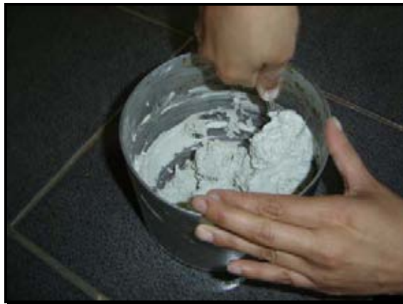
Imagen 3-2.- Preparación Pasta Normal de Cemento Blanco (2)
