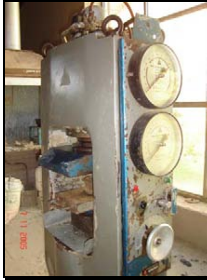
Imagen 3-15.- Máquina para ensayo de Compresión
