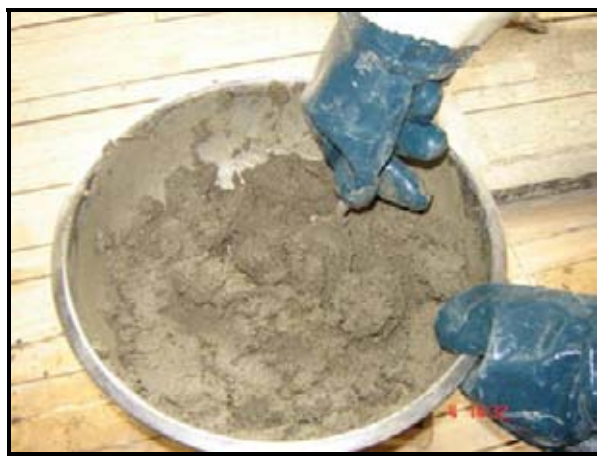
Imagen 3-7.- Preparación de Mortero Normal (método mezclado manual)
