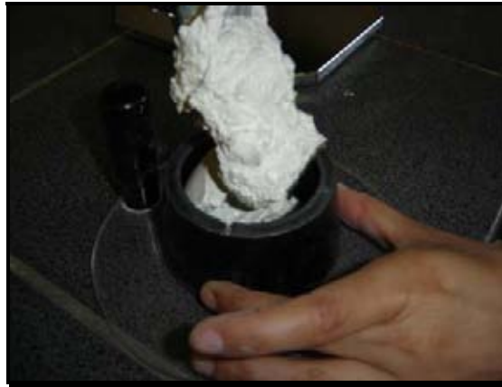
Imagen 3-3.- Vaciado Pasta Normal de Cemento Blanco al Molde Tronco - cónico
