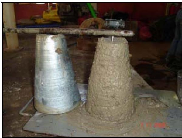
**Imagen 3- 8.- Medición del Asentamiento del Cono**
