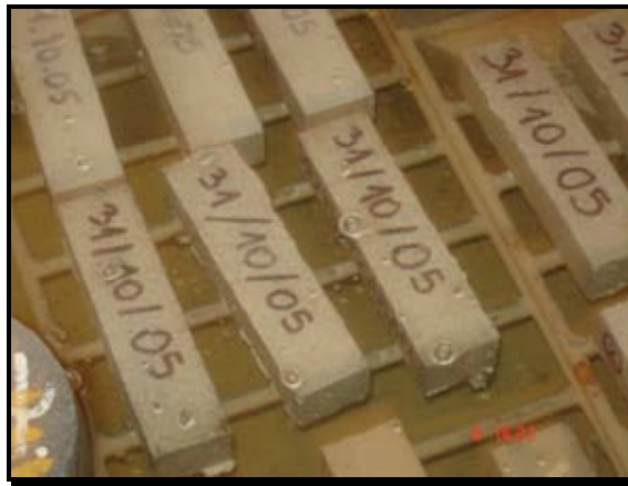
Imagen 3-13.- Probetas desmoldadas y sumergidas en agua.
