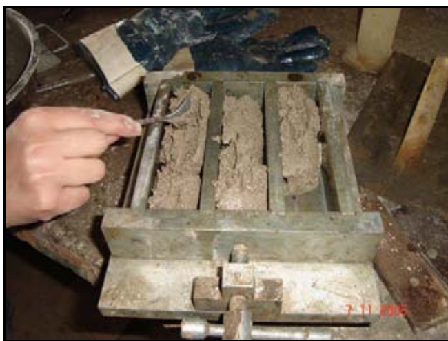
Imagen 3-9.- Llenado de moldes Rilem
