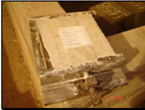
Imagen 3-12.- Molde identificado y conservado en cámara húmeda
