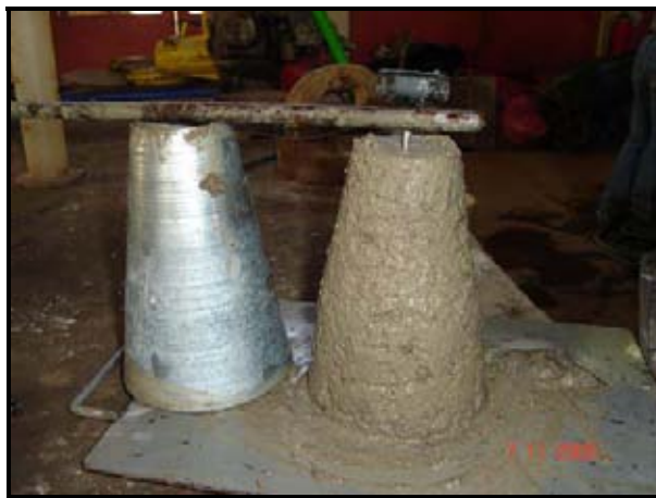
Imagen 3- 8.- Medición del Asentamiento del Cono Fuente: elaboración propia (2005)
