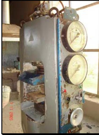
**Imagen 3-15.- Máquina para ensayo de Compresión**
