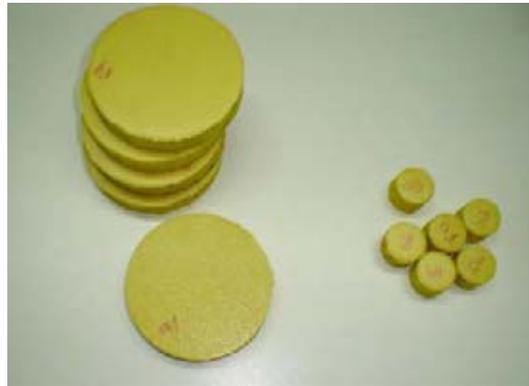
Figura 3.2: Muestras del material de PVC de 97 mm y de 28 mm de diámetro.
