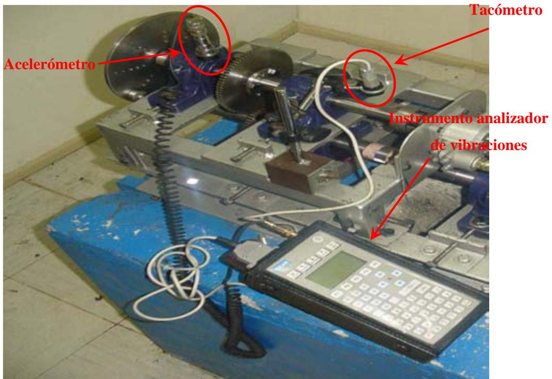
Figura N° 48. Montaje del instrumento.
