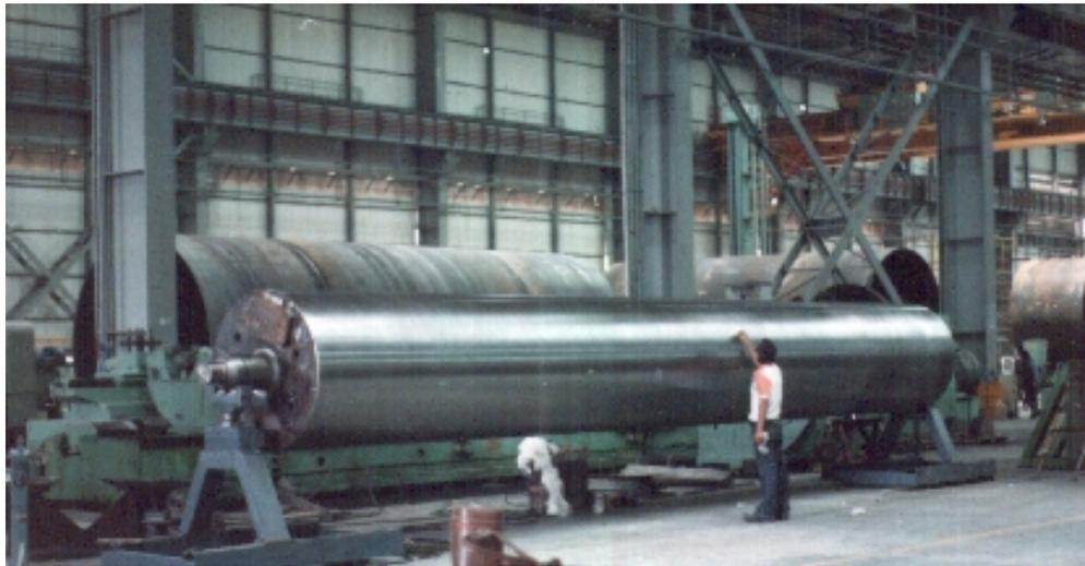
Figura N° 7 “Muestra un rodillo de la industria papelera” (véase referencia 16).
