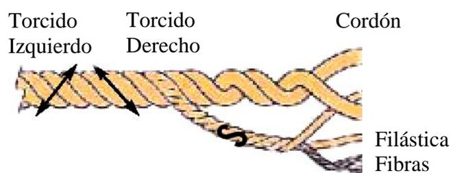
Figura 2.2 Composición de un Cabo
