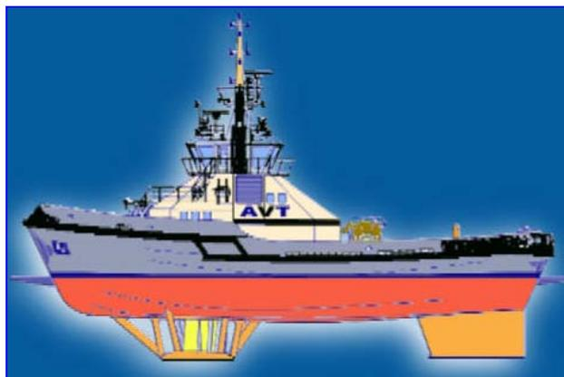
*Figura 4.3 Remolcador equipado con propulsores Voith Schneider*
