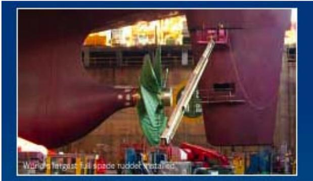
Figura 3.2 Montaje de un Timón Suspendido
