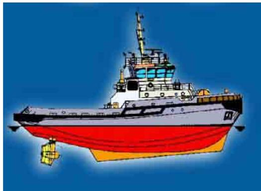
Figura 4.4 Remolcador con propulsión azimutal de popa
