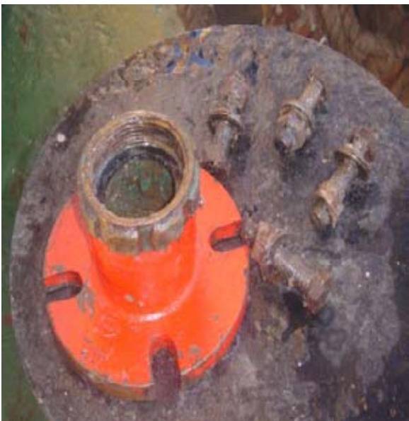
Figura 2.8 Copla con sus 4 pernos
