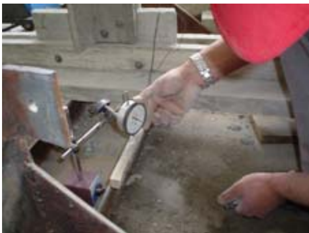
fig. No 58 Deformación en el centro de la cercha.
