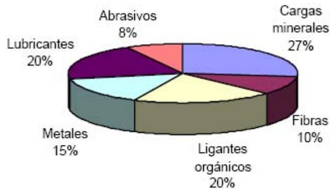
**Fig. 2.7:** Composición porcentual de los materiales de fricción.
