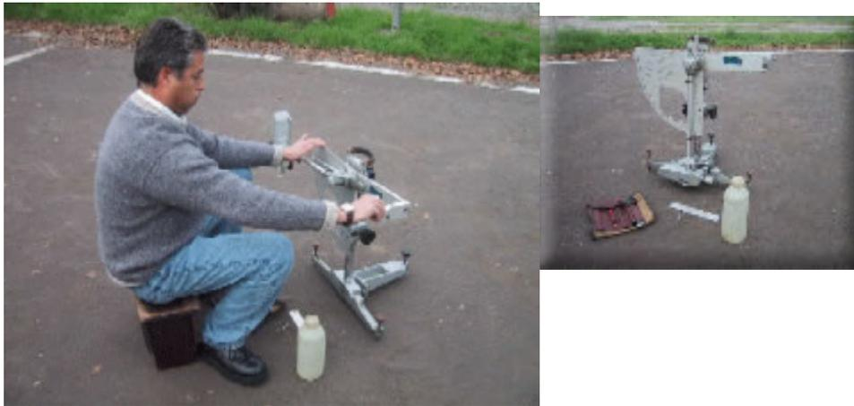
Este ensayo consiste en medir la pérdida de energía de un péndulo provisto en su extremo de una zapata de goma, cuando la arista de la zapata roza, con una presión determinada, sobre la superficie a ensayar en una longitud fija. Esta pérdida de energía se mide por el ángulo suplementario de la oscilación del péndulo.
