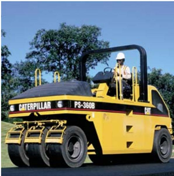
**4.3 Compactación Final:** La compactación final debe realizarse con rodillos tandem de dos ruedas o tres, mientras que el material es aún suficientemente trabajable para permitir suprimir las huellas de los rodillos.
