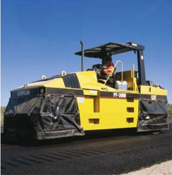
La cantidad, peso y tipo de rodillos que se empleen deberán ser el adecuado para alcanzar la compactación requerida dentro del lapso de tiempo durante el cual la mezcla es trabajable.
