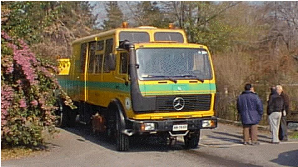
Para medir posee un sistema de trineo que se apoya en el suelo mediante tres puntos que constituyen un plano de referencia fijo para la determinación del cero, el camión recorre una distancia para las mediciones y cuando las ruedas gemelas llegan a los palpadores se registra la deflexión máxima, avanza el trineo al doble de la velocidad del camión y se pone en posición para iniciar nuevamente el ciclo.
