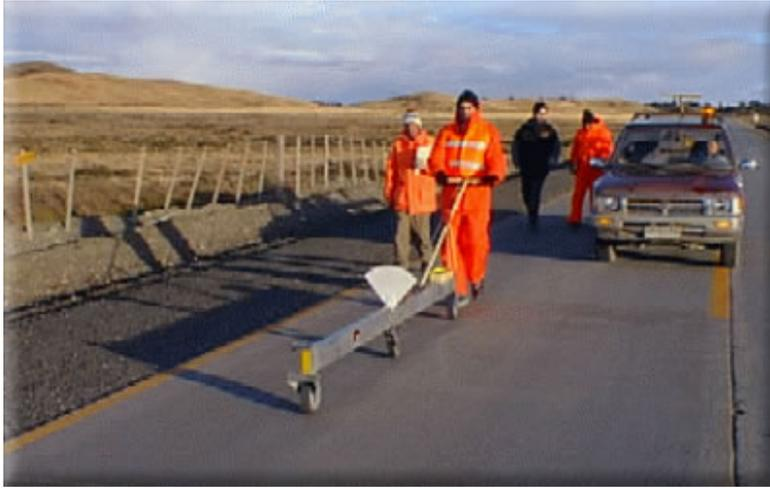
El detector Hi-Lo es una regla rodante que permite medir la irregularidad de la superficie. Este equipo está conformado por una viga metálica indeformable que se traslada sobre tres ruedas. Una rueda, la detectora, dispuesta al centro de la viga, se desplaza verticalmente por los altos y bajos de la superficie del pavimento.
