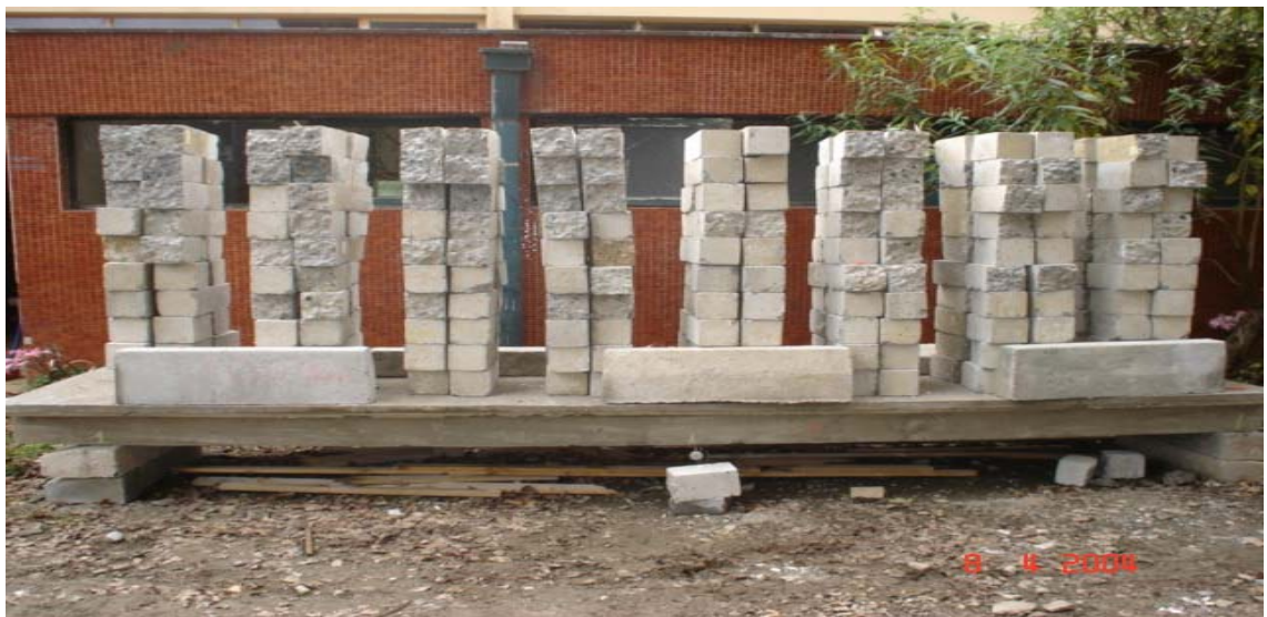
Ilustración 5-6: Losa con carga máxima de ensayo (Se utilizaron Soleras a ambos lados de la losa, para simular de mejor manera la carga máxima de forma distribuída).
