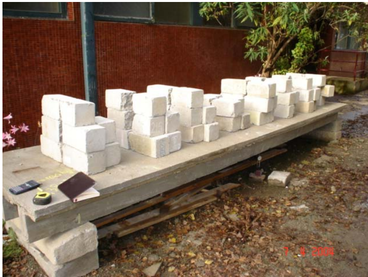
Ilustración 5-3: Losa cargada con viguetas
