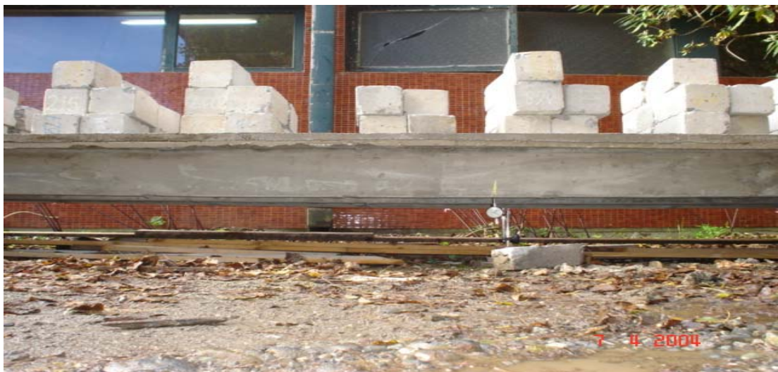
Ilustración 5-2: Ensayo de Losa de Ferrocemento
