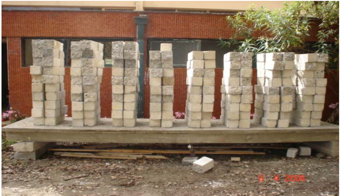
Ilustración 5-5: Losa con incremento de carga
