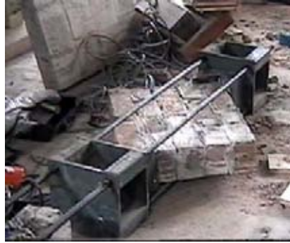
Foto n° 27. Ensayo de murete.
