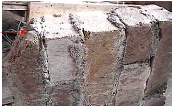
Foto n° 28. Murete después de ensayado.
