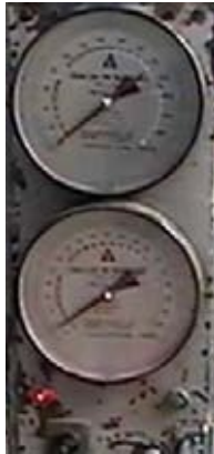
Foto nº 19. Dispositivo de medida de cargas aplicadas.
