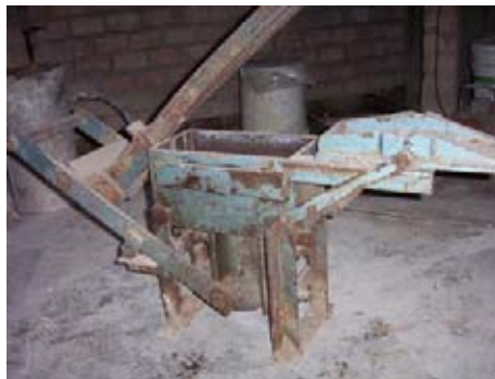
Foto nº 6 Bloquera manual ocupada en la confección de bloques.
