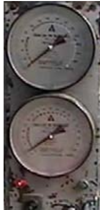
Foto nº 19. Dispositivo de medida de cargas aplicadas.
