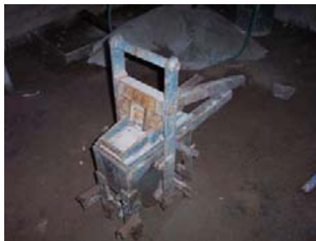
Foto nº 10 Bloquera con hormigón compactado.
