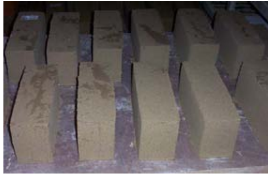
Foto nº 13 bloques en sala de curado.
