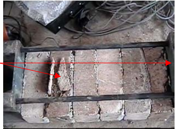
Foto nº 31. Prisma después de ensayado.
