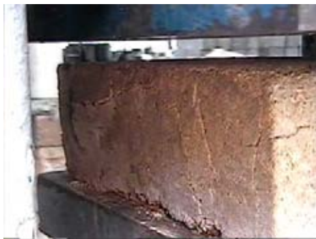
Foto nº 22. Bloque después de ensayo.
