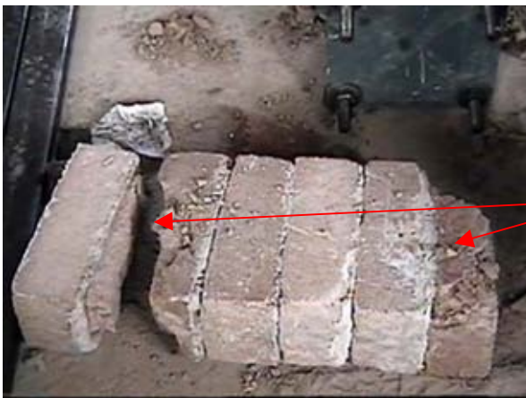
Foto nº 32. Prisma después de ensayado.
