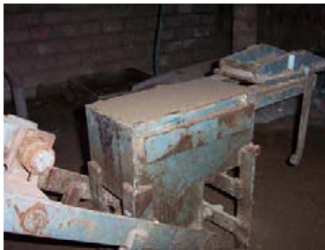
Foto nº 9 Bloquera manual con material a compactar.
