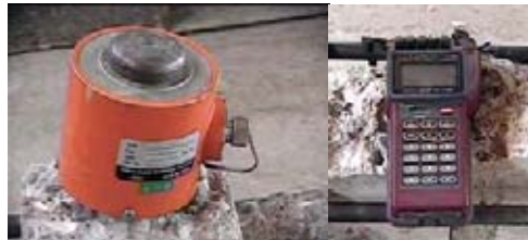
Foto nº 25. Celda de Carga y reloj.
