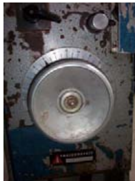
Foto nº 20. Volante regulación de velocidad ensayo de compresión.
