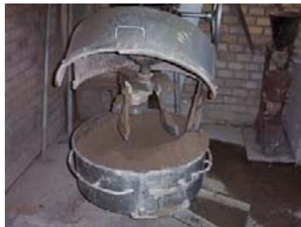
Foto nº 8 hormigón preparado para confección de bloques.
