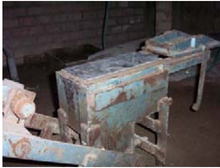
Foto nº 11 Bloquera con placa de metal para extracción de bloques.
