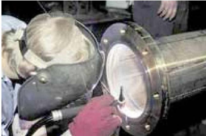
fig 2.3.1 Proceso de soldadura TIG
