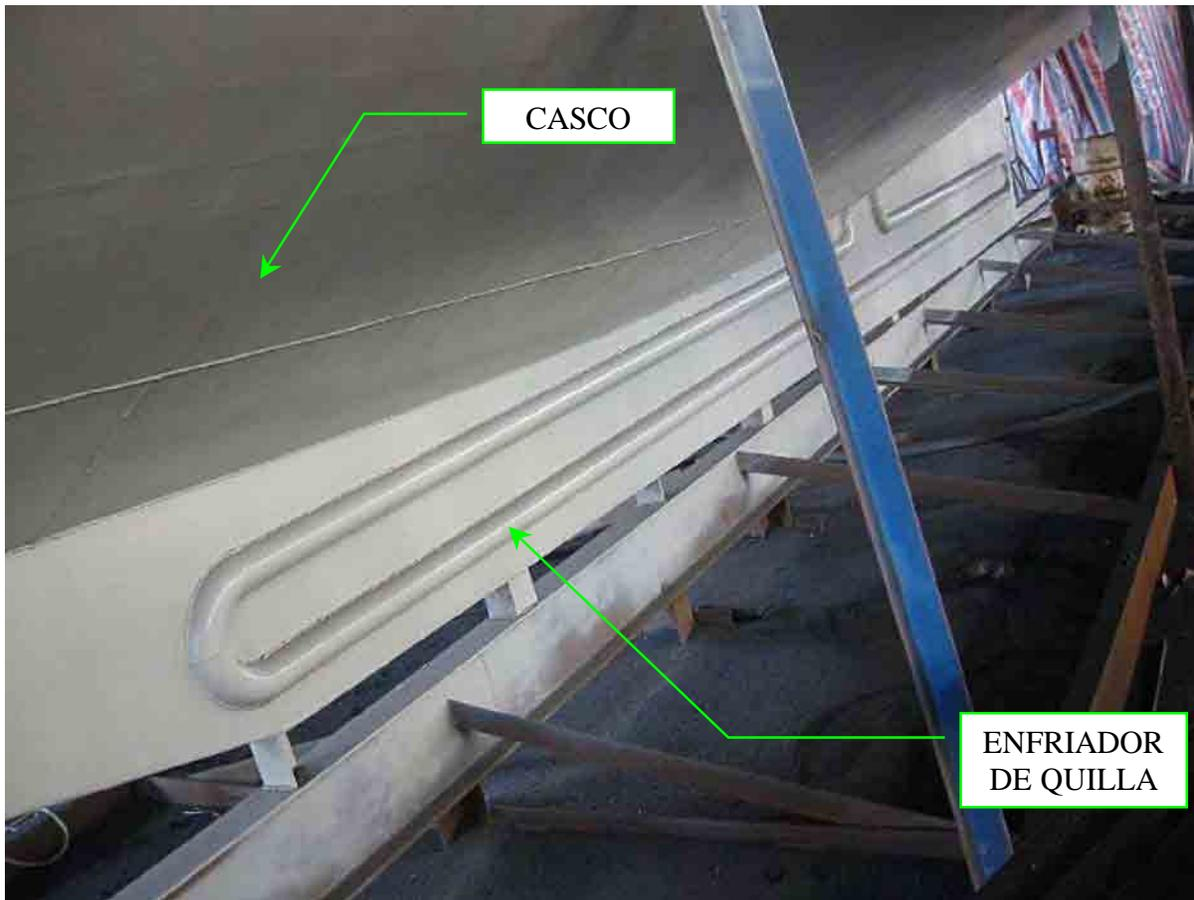
fig 1.2.6. Enfriador de quilla tipo estructural
