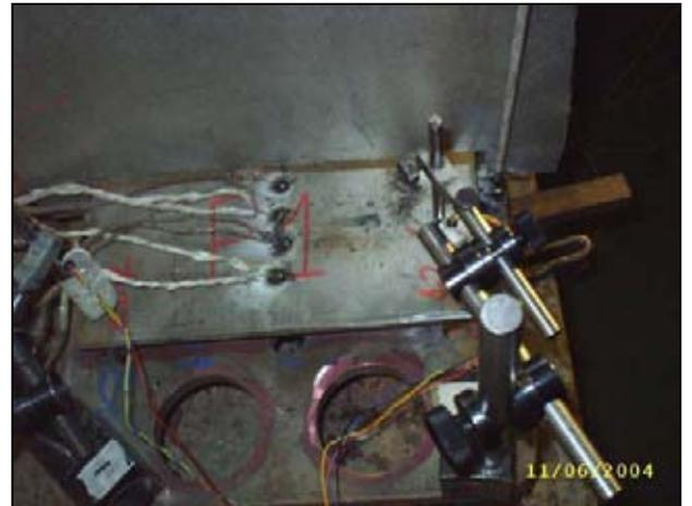
Posición de las termocuplas en la probeta para analizar distribución de temperaturas.
