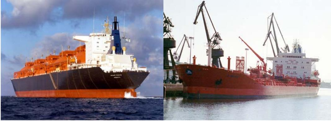
Otro tipo de buques son los gaseros, que tienen una construcción especial, dentro del casco en la línea de proa y popa, tiene instalados tanques, que pueden presentar distintas formas, siendo los más comunes los esféricos, por ser la configuración que resiste mejor las presiones interiores.
